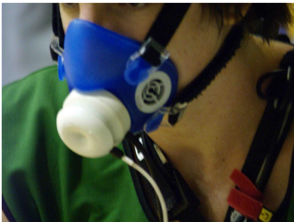
Figura 10. Detall del muntatge de la màscara on s'emporten la turbina i el permature
