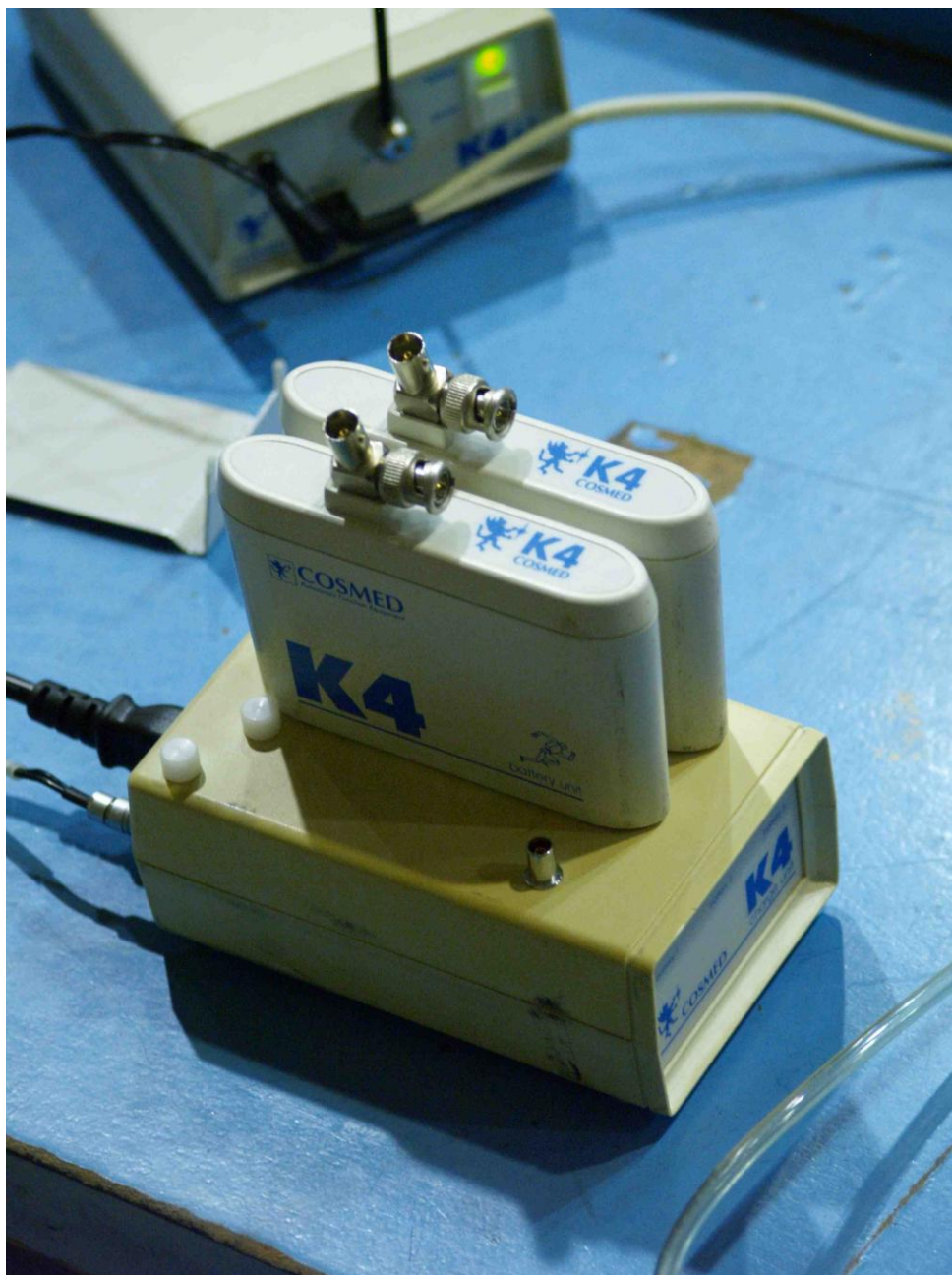
Figura 12. Detall del muntatge del K4b 2 : bateries i unitat receptora
