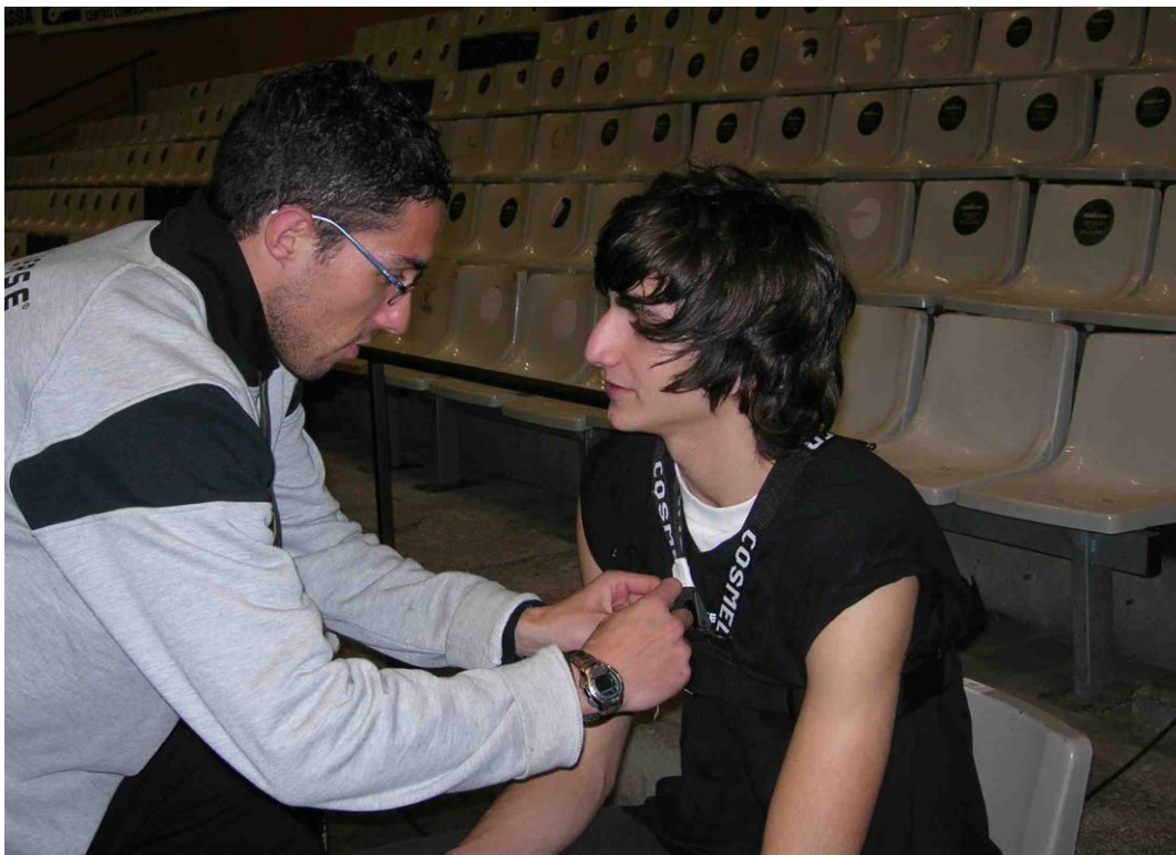
Figura 13. Col·locació de l'analitzador de gasos en un dels jugadors participants
