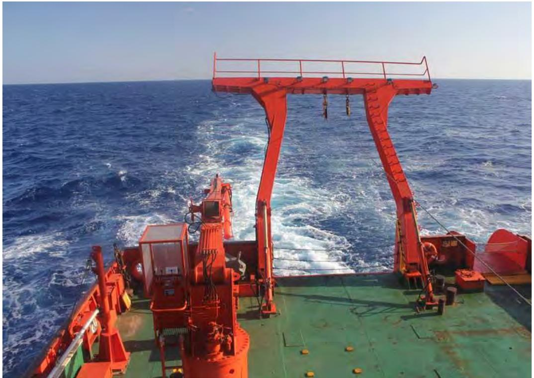
**Figura 2.11: Popa del B.I.O. Hespérides, arrastrando un magnetómetro (Fuente: Fotografía propia 2011)**
