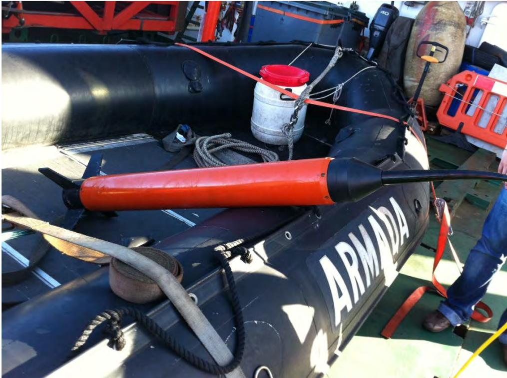
**Figura 2.12: Magnetómetro del Hespérides. (Fuente: Fotografía propia 2011)**
