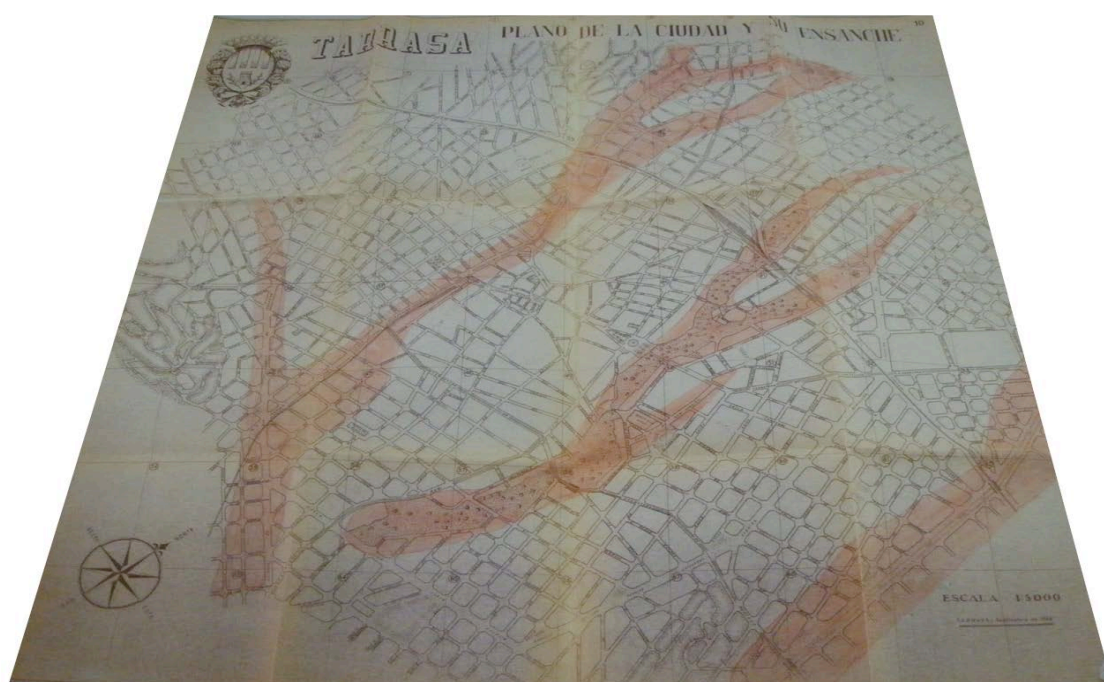
Figura 5.5: Plànol antic de la ciutat de Terrassa on, manualment, es van marcar les zones més afectades per la riuada de 1962. Evidentment, coincideixen amb el curs fluvial de les tres principals rieres de la ciutat.
