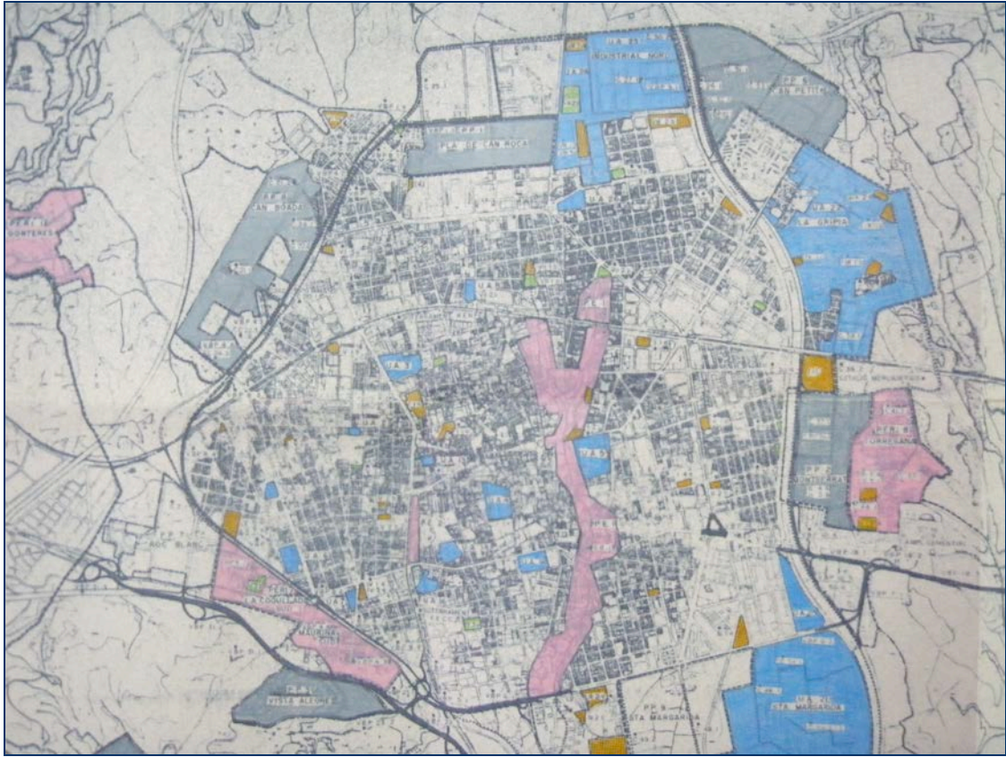
Figura 5.7: Visió general de les propostes de Plans Parciais (en gris), Plans Especials (en rosa) i Unitats d'Actuació (en blau) que proposa el Pla de 1983. Hom pot observar que l'únic curs fluvial que rep un tractament integral sota la forma de proposta futura de Pla Especial és el torrent de Vallparadís, situat al centre de la ciutat.
