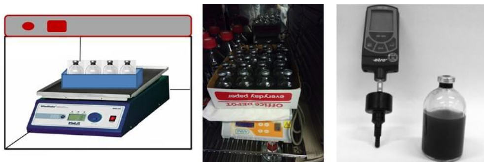
Figura 4. Material per dur a terme el Test BMP
