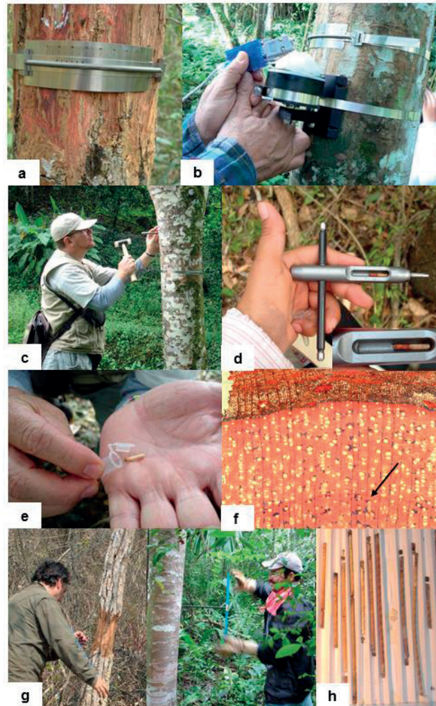
Figura 1. Métodos utilizados para evaluar el crecimiento radial de los árboles a una escala intra-anual y determinar la densidad de la madera. Las figuras superiores muestran dendrómetros de banda manual (a) y automático (b) colocados respectivamente en Aspidosperma cylindrocarpon ubicado en el BsT de la Chiquitanía (INPA) y en Cordia alliodora localizado en un bosque seco interandino de Colombia (Tuluá) mostrando la descarga de datos. Obtención de un mini-core con el extractor Trepbor (c-e), aspecto de un corte histológico (f) mostrando un límite de un anillo de crecimiento (flecha) en Acosmium cardenasii , una especie arbórea endémica del BsT de la Chiquitanía (Bolivia). Extracción de muestras de madera con la barrena de Pressler (g), testigos cilíndricos de madera recolectados para cuantificar la densidad de la albura (h).
