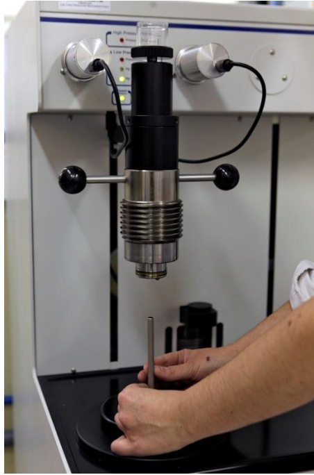
Figura 22. Porosímetro de mercurio, modelo AutoPore IV 9500.
