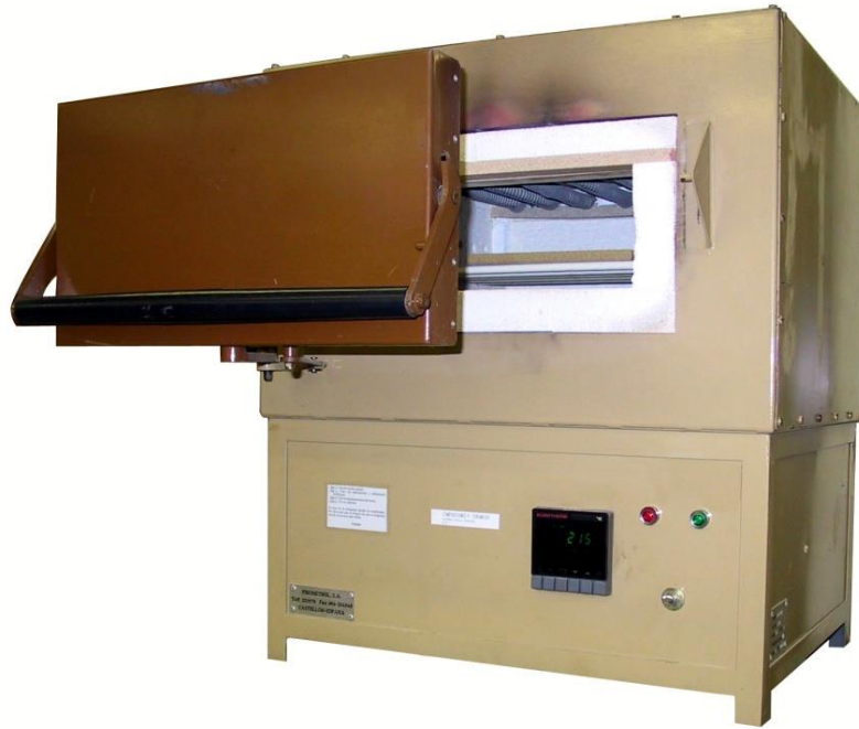
Figura 21. Hornos modelo Rápido, usados para la síntesis de las membranas cerámicas.
