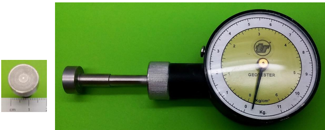
Figura 19. Penetrómetro analógico modelo Geotester 0-6 kg y detalle del cilindro de 1,5 cm de diámetro.
