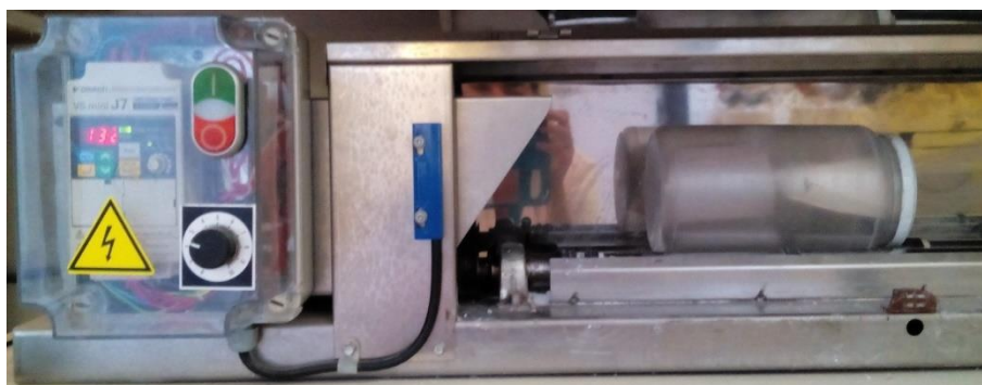
Figura 16. Dispositivo de fabricación propia empleado para granulación en seco.
