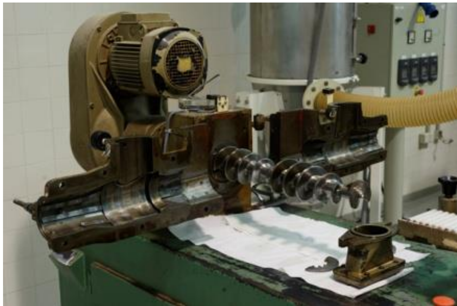
Figura 20. Extrusora de laboratorio modelo 050C.
