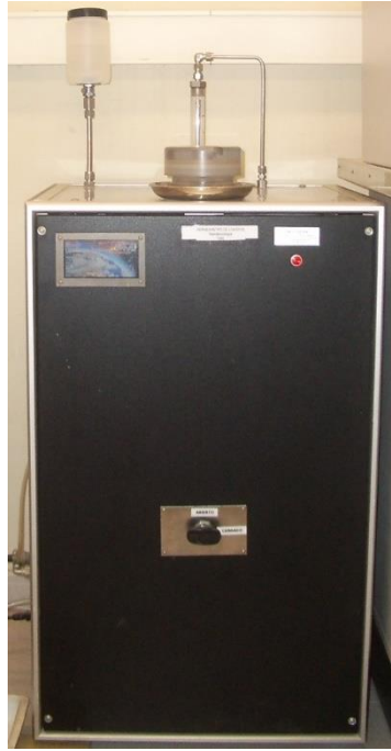
Figura 25. Permeámetro automático modelo LEP101-A.
