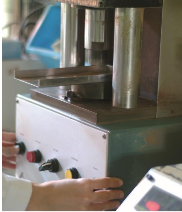
Figura 18. Prensa unidireccional de laboratorio modelo Mignon.
