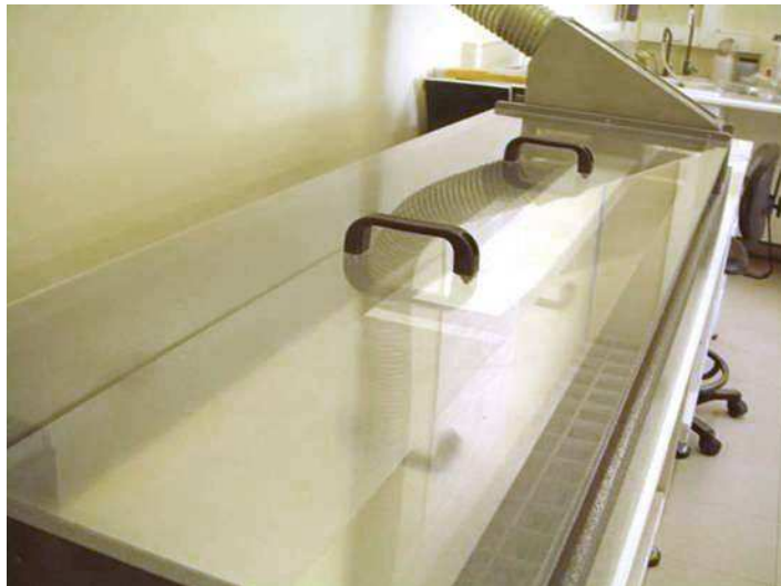
Figura 3.10. Fotografía del dispositivo de colado en banda.
