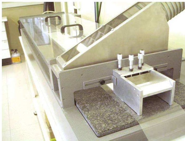
Figura 3.11. Vista del dispositivo de colado en banda. Detalle de la cuchilla de alimentación.
