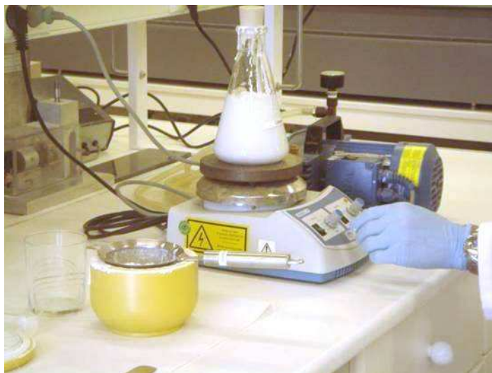
Figura 3.8. Detalle del proceso de desaireación realizado.
