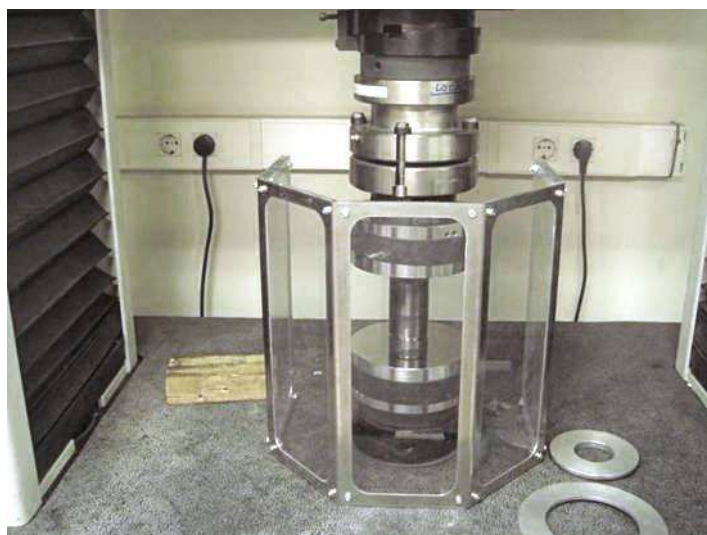
Figura 3.7. Detalle del montaje experimental utilizado para el prensado de las probetas.
