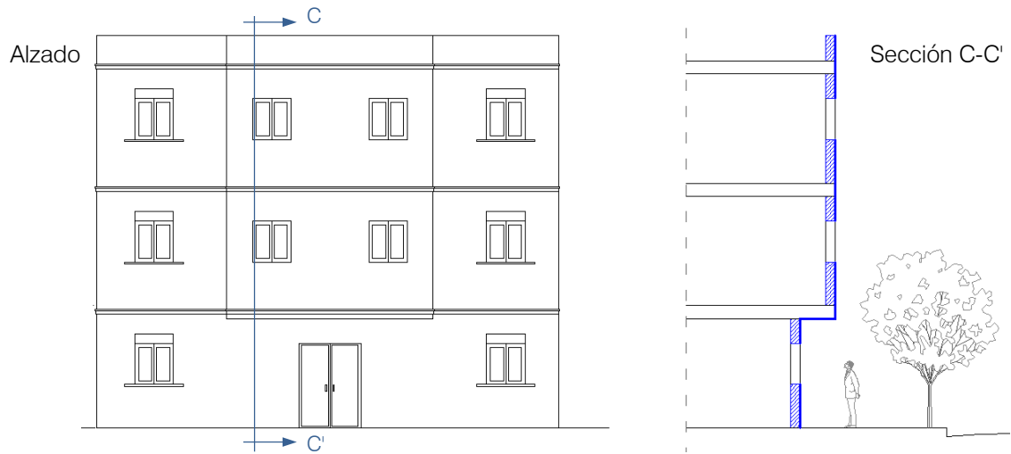
Figura 3.9 Fachada con tribuna
