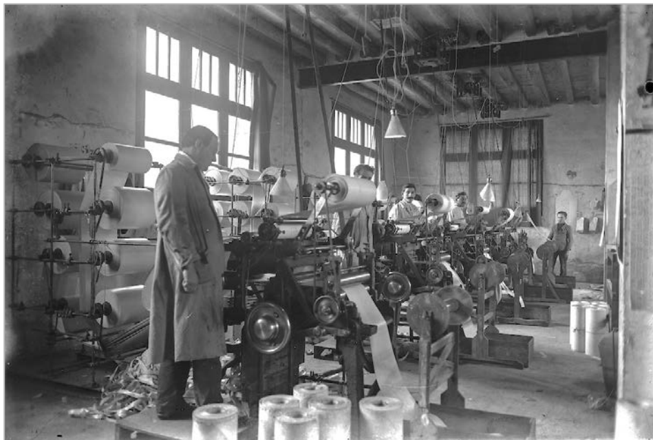
Fig. 3-8 Fotografia de la maquinària emprada a La Solfa per a perforar els rotlles en sèrie. Font: Fons Manuel Blancafort, BC.
