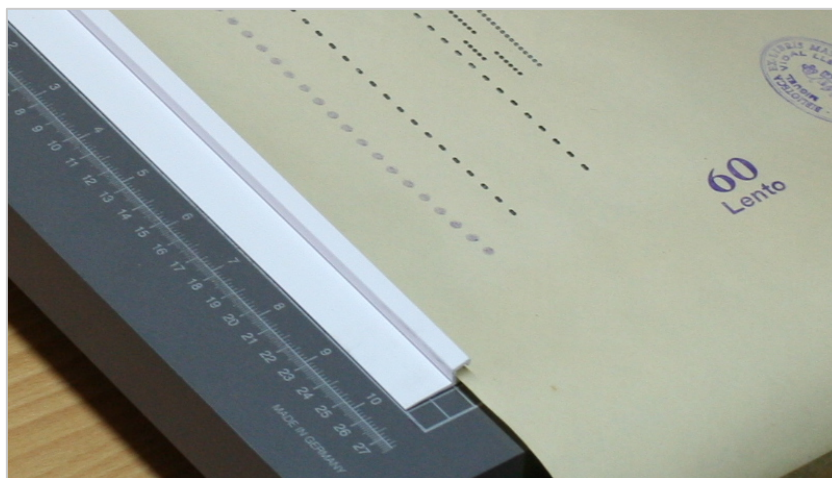
Figs. 4-7 i 4-8 Sistema de subjecció de la càmera i guies adhesives utilitzades per al transport del rotlle.
