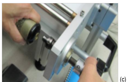
Fig. 4-15 Detall del sistema d'ancoratge en un rotlle de pianola Victoria (a) i sistema de subjecció del Pianola Roll Digitizer (b i c).
