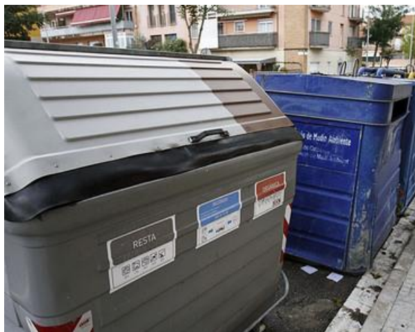
Fig. 2.12 -. Modelo de contenedor de carga bicompartimentada.
