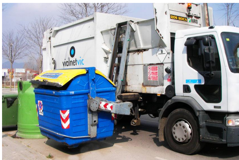
Fig. 2.19 -. Recogida mediante carga lateral, de un contenedor envases y resto
