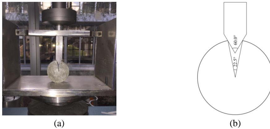
Figure 6.9: Dispositif expérimental pour l'essai de fendage par coin.
