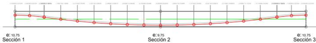
Figura 6-22. Trazado de la banda principal de armadura activa para la placa de 12x12 metros
