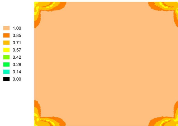
Figura 8-126. Variación de D22 tras el análisis no lineal para un refuerzo de 1\Phi 20c/20(x) y 1\Phi 20c/15(y) en el problema de 12 \times 14m
