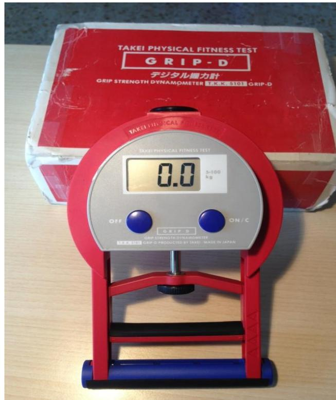
*Figura 51. Dinamómetro manual utilizado para la prueba de valoración de la fuerza de prensión.*
