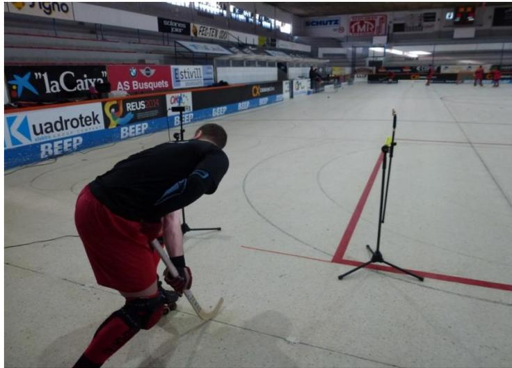
*Figura 50. Detalle de la disposición de la célula fotoeléctrica en la salida de la prueba de 25 m esprint con cambios de dirección.*
