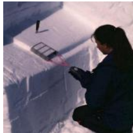
(d) Shear frame test
