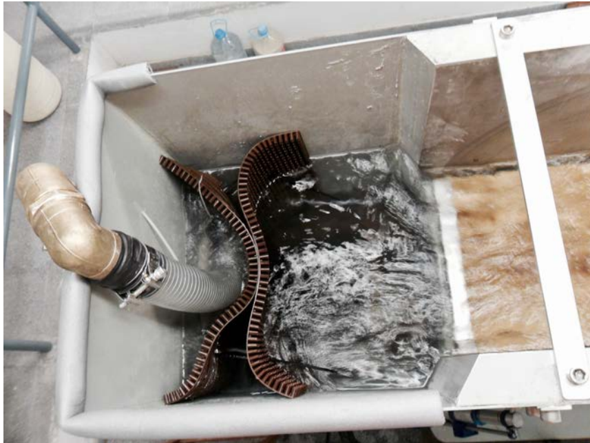
Figura A62. Entrada de l'aigua al canal. Es col·loquen elements dissipadors i rectificadors del flux.
