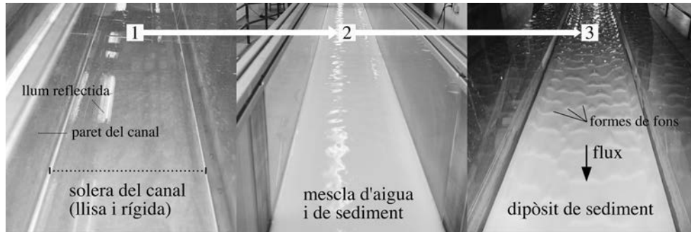
Figura 25. La rugositat del fons varia durant l'experiment per la sedimentació de llim. 1: solera metàl·lica del canal a l'inici de l'experiment; 2: superfície lliure durant el transcurs d'un experiment; 3: dipòsit de llim visible a l'aturar l'experiment.
