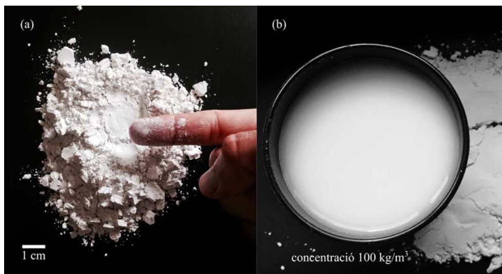
Figura 13. Pols de quars. (a) Per la mida de les partícules es formen aglomerats de cohesió molt baixa. S'assembla, en el tacte i la vista, a la farina. (b) Suspensió d'aigua i pols de quars. L'aspecte és el de la llet.
