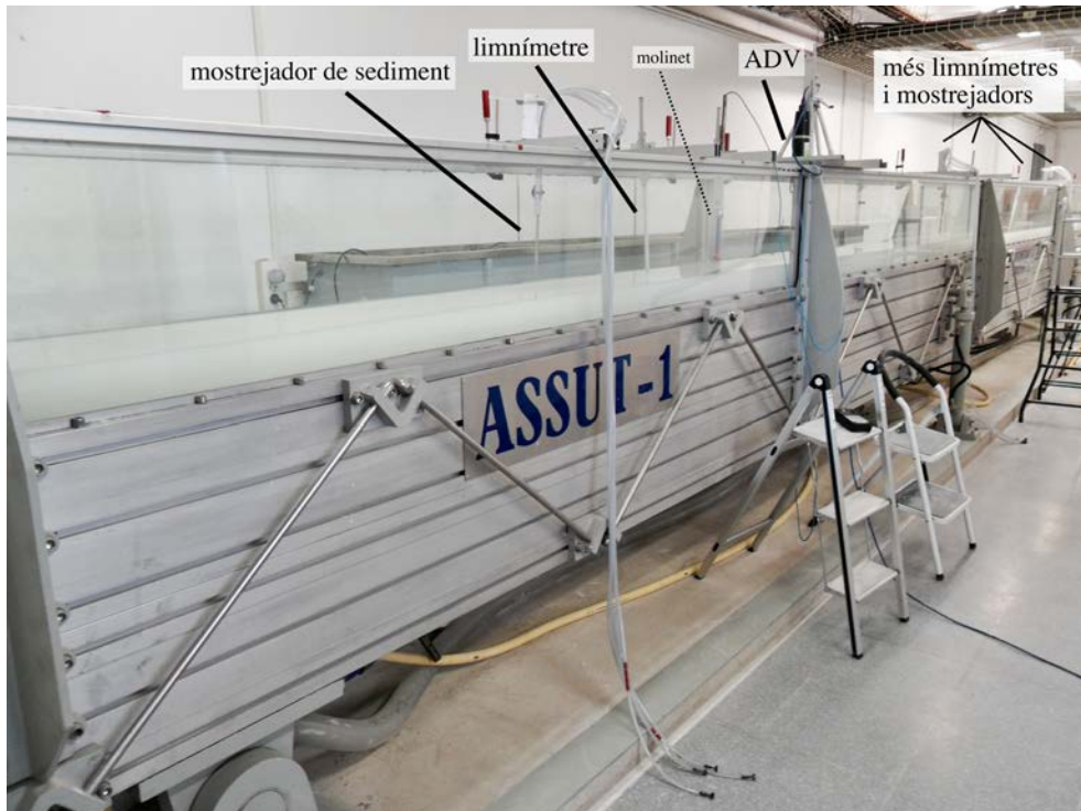
Figura A67. Experiment ordinari 3 en marxa. El flux va de dreta a esquerra.
