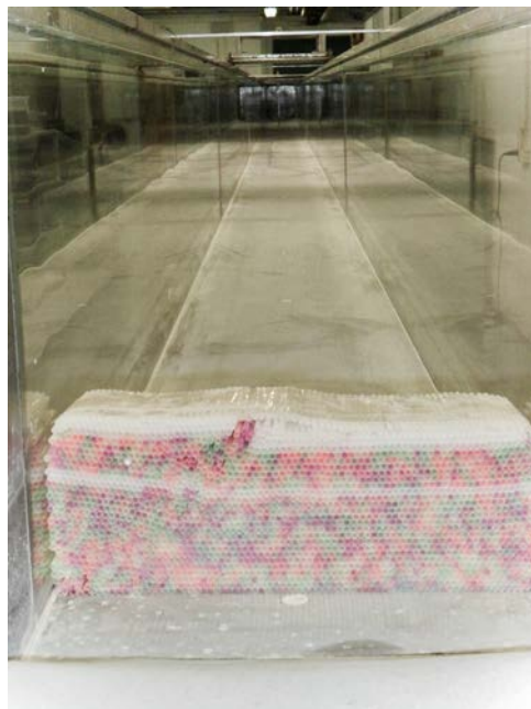
Figura A63. L'últim element rectificador que travessa el flux (d'inspiració modernista) abans de recórrer els 14.75 m de canal. El sentit del flux és cap endins de la imatge.
