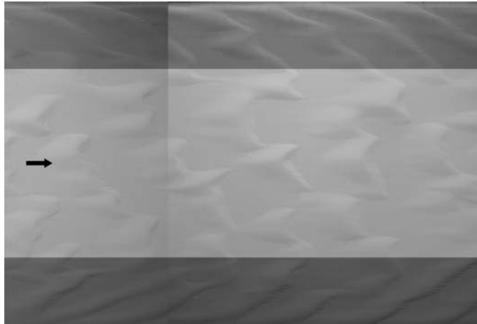
Figura 48. Efecte de les parets laterals del canal en el dipòsit de llim (experiment 1, x = 10.5 m). La fletxa indica el sentit del flux i té una longitud de 3 cm. Cada franja enfosquida mesura 7.7 cm d'amplada, aproximadament 1/5 part de l'amplada del canal de 0.37 m.
