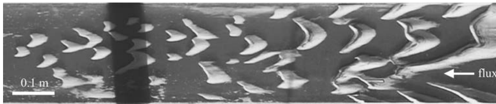
Figura 50. Formació de barcanes amb un flux unidireccional a partir d'una acumulació de sorra de 0.1 mm. Font: modificat de Endo et al. [2005].
