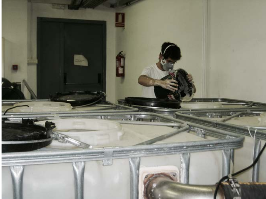
Figura A58. Introducció de la pols de quars en els tancs (l'ús de la mascareta és obligatori).
