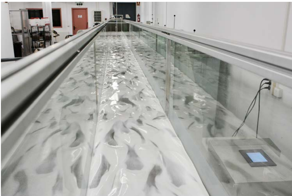
Figura A69. Dipòsit de llim en un experiment de suport. La sortida del canal de la mescla d'aigua i de llim romanent va alterar les formes de fons. El sentit del flux és cap endins de la imatge.
