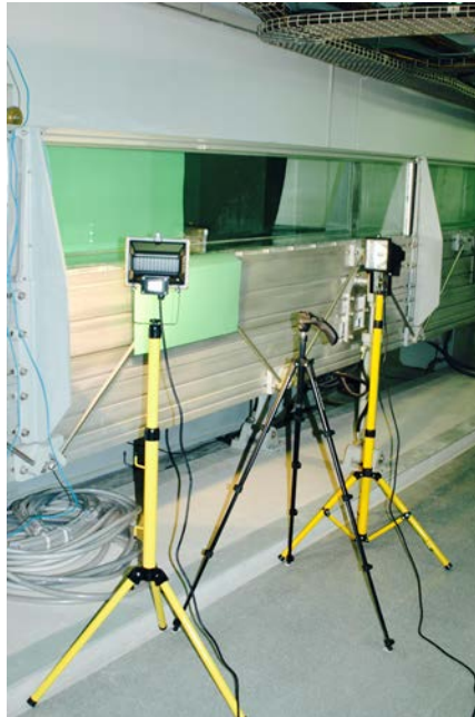
Figura A70. Instal·lació per mesurar la concentració de llim a partir de fotografies en condicions de llum controlades. Malauradament, no va funcionar.
