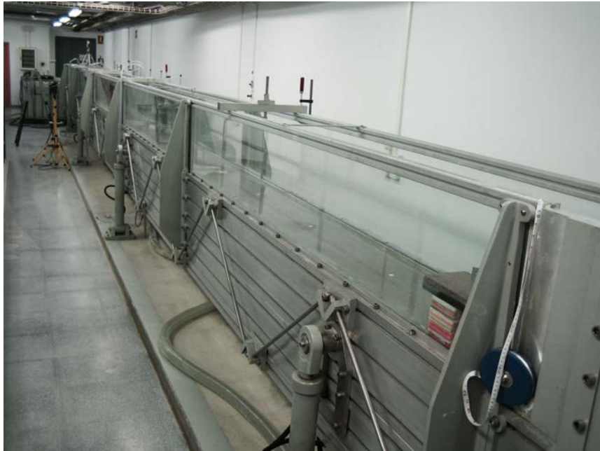
Figura A64. Vista lateral del canal. En primer pla a la dreta, l'element tranquil·litzador de la Figura A63. Els tancs d'aigua apareixen al fons de la imatge.
