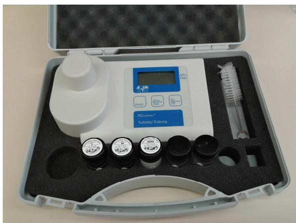
Figura 3.20. Turbidímetro.
