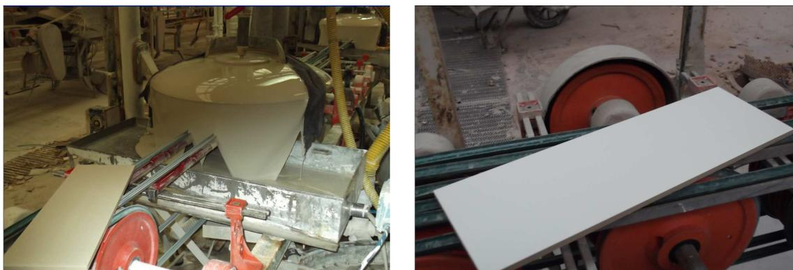
Figura 4.43. Proceso de aplicación del engobe elaborado con las aguas nanofiltradas.
