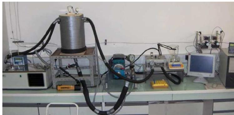
Figura 3.3. Foto de la planta de filtración tangencial escala laboratorio del IEM.
