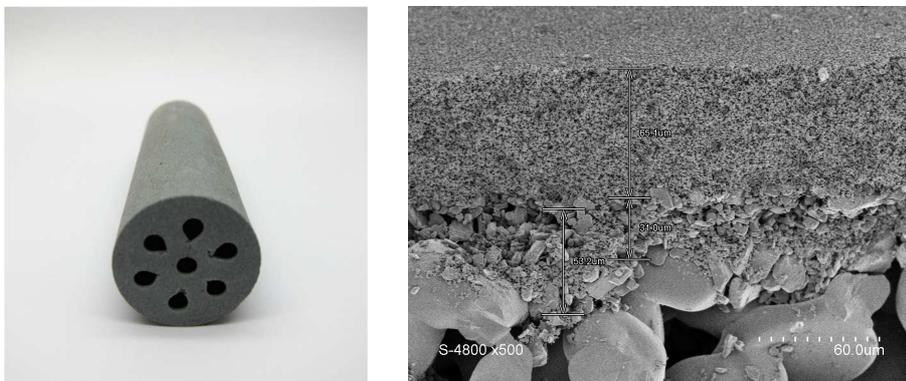
Figura 1.24. Membrana cerámica de SiC desarrollada en el ITC e imagen MEB de una membrana del mismo tipo.
