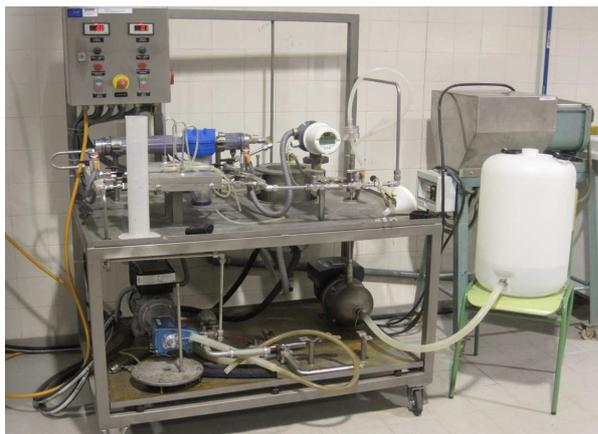
Figura 3.21. Montaje para la determinación del SDI en el ITC.
