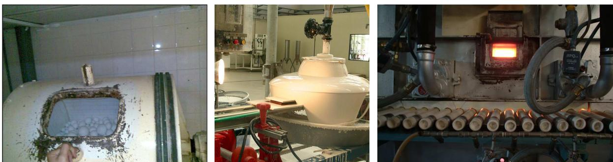
Figura 3.25. Molino de bolas, aplicación de un esmalte por campana y etapa de cocción, a escala industrial.
