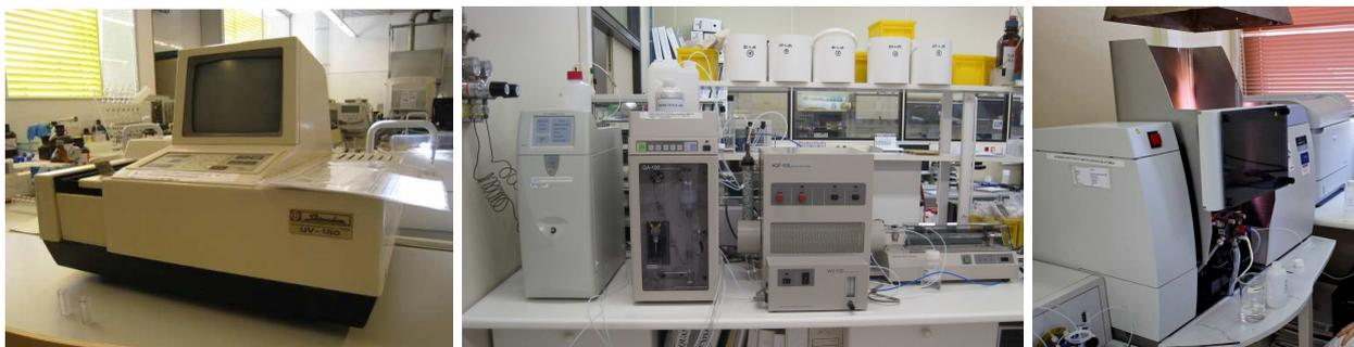
Figura 3.17. Espectrofotómetro, cromatografía iónica y espectrofotómetro de absorción atómica, respectivamente.
