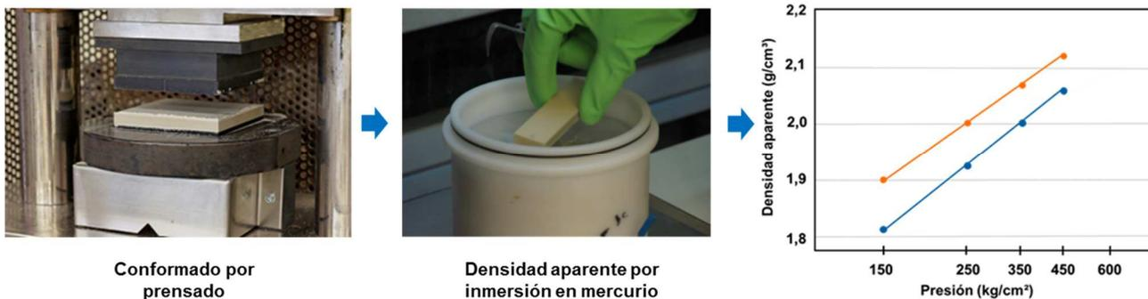
Figura 3.27. Esquema de los pasos seguidos para la obtención del diagrama de compactación.
