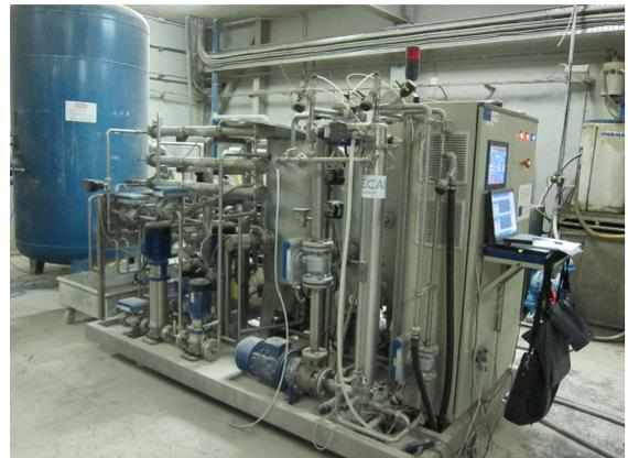
*Figura 3.8. Planta piloto de filtración avanzada del ITC. Vista general del piloto tomada en ITC y ubicación del piloto en las empresas participantes en los casos de estudio (eliminación de compuestos de boro y sales divalentes), respectivamente.*
