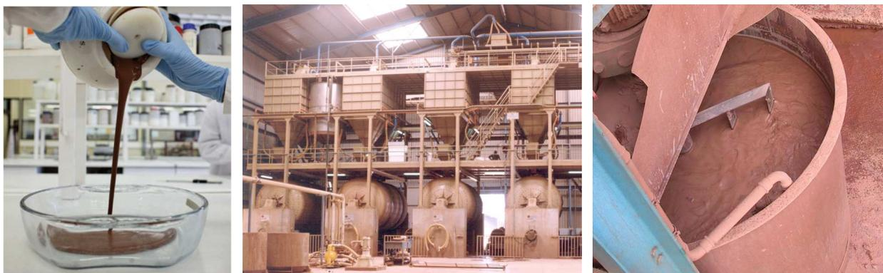
Figura 1.15. Descarga de la suspensión de un molino de laboratorio, sección de molinos de una empresa y suspensión cerámica industrial, respectivamente.
