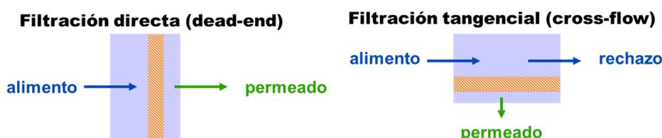
Figura 1.32. Modos de filtración: frontal y tangencial, respectivamente.
