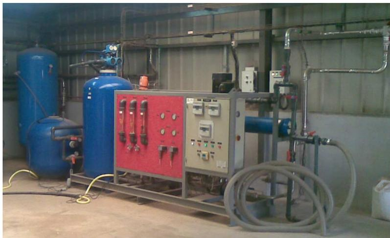
Figura 1.13. Instalación de ósmosis inversa en el sector cerámico.
