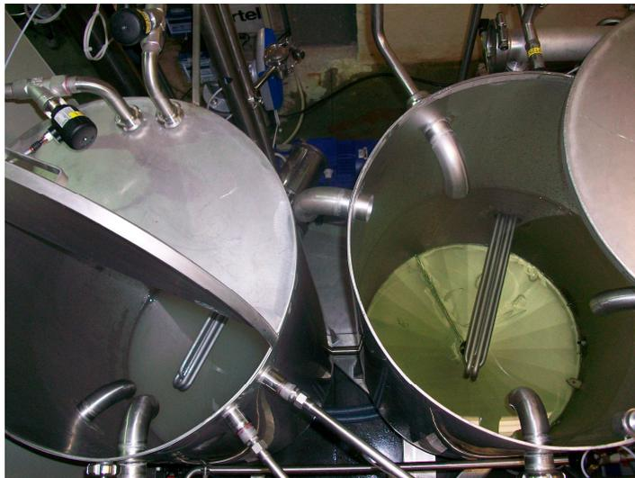
*Figura 4.33. Vista superior del depósito de MF (izquierda) con agua sucia en el fondo antes de la MF y depósito de NF (derecha) medio lleno con agua trasparente (amarillenta) después de la MF (y antes de la etapa de NF).*
