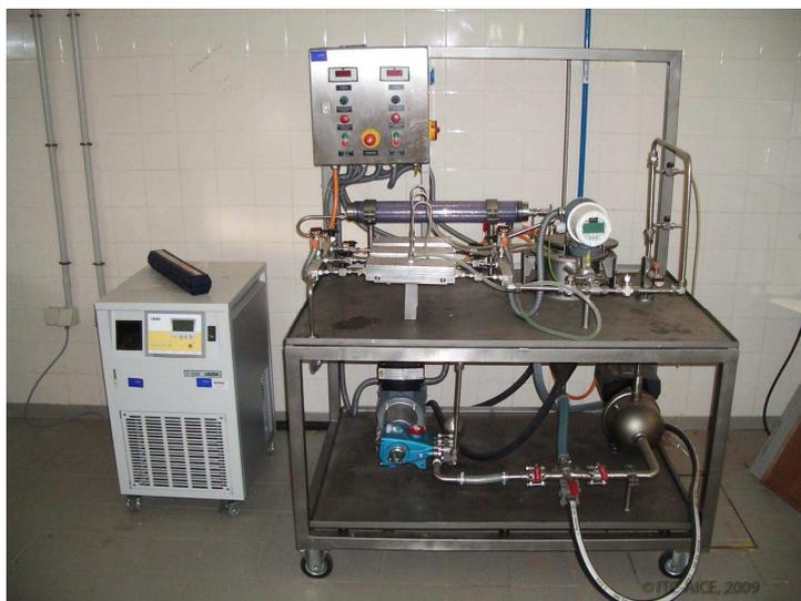
Figura 3.6. Planta de separación de efluentes líquidos mediante membranas a escala de laboratorio del ITC.
