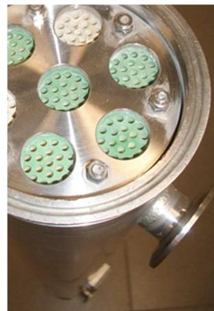
Figura 3.1. Membranas de microfiltración (MF) tubulares. a) Membranas KLEANSEP™ 300 kD b) Detalle de las membranas KLEANSEP™ 0,1 µm introducidas dentro de su cárter de filtración.
