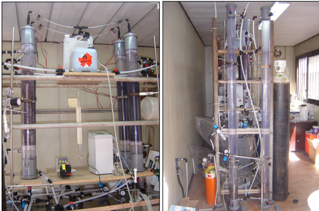
Figura 2.1 Muntatge dels biofiltres convencionals
