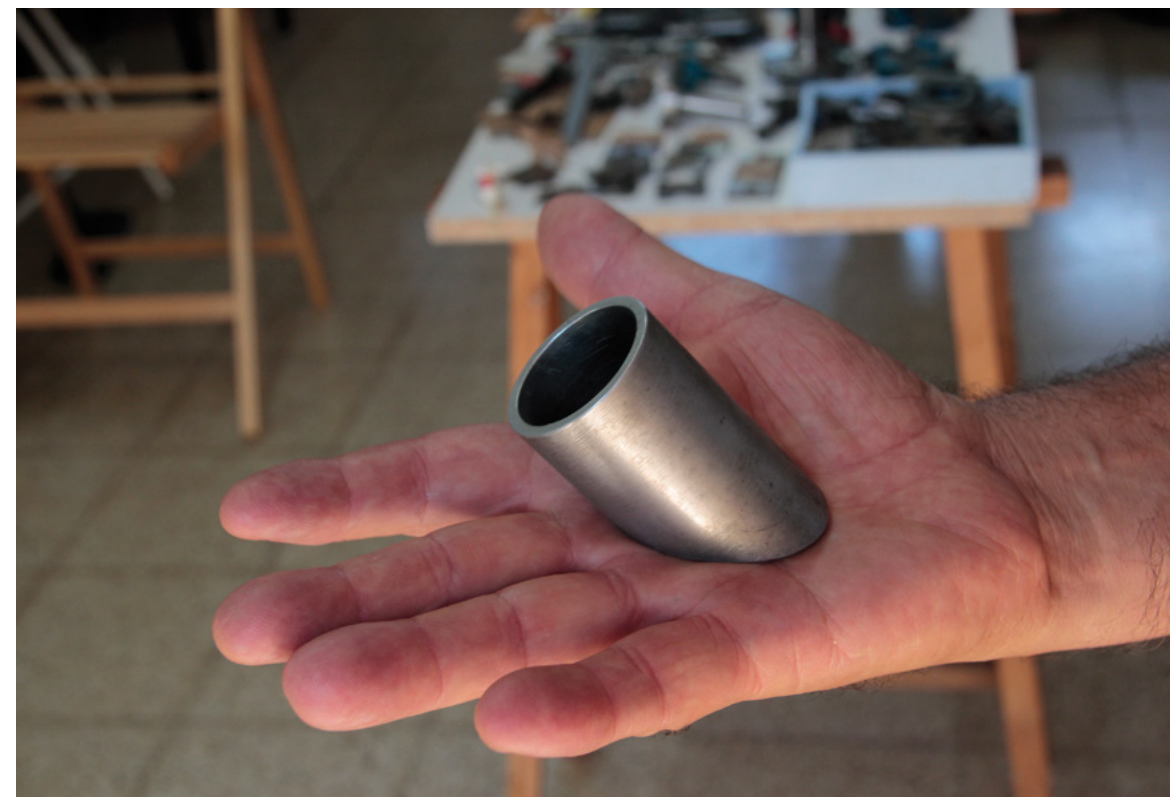
Fotografia 76 Tub d'acer 31,5 x 32 x 59 mm
