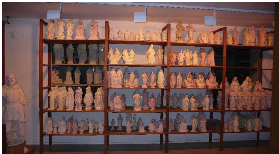
fig. 129 Sala de curat de figures de cartó fusta. Les tonalitat blanques determinen el final del procés d'assecat i duresa, les roses contenen massa humitat i resten encara tendres. Museu dels Sants d'Olot.
