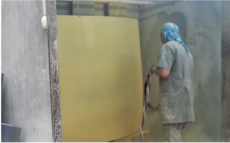
Fig. 23. Proceso de esmaltado de la lámina de acero. Foto: Sylwia Ulicka.
