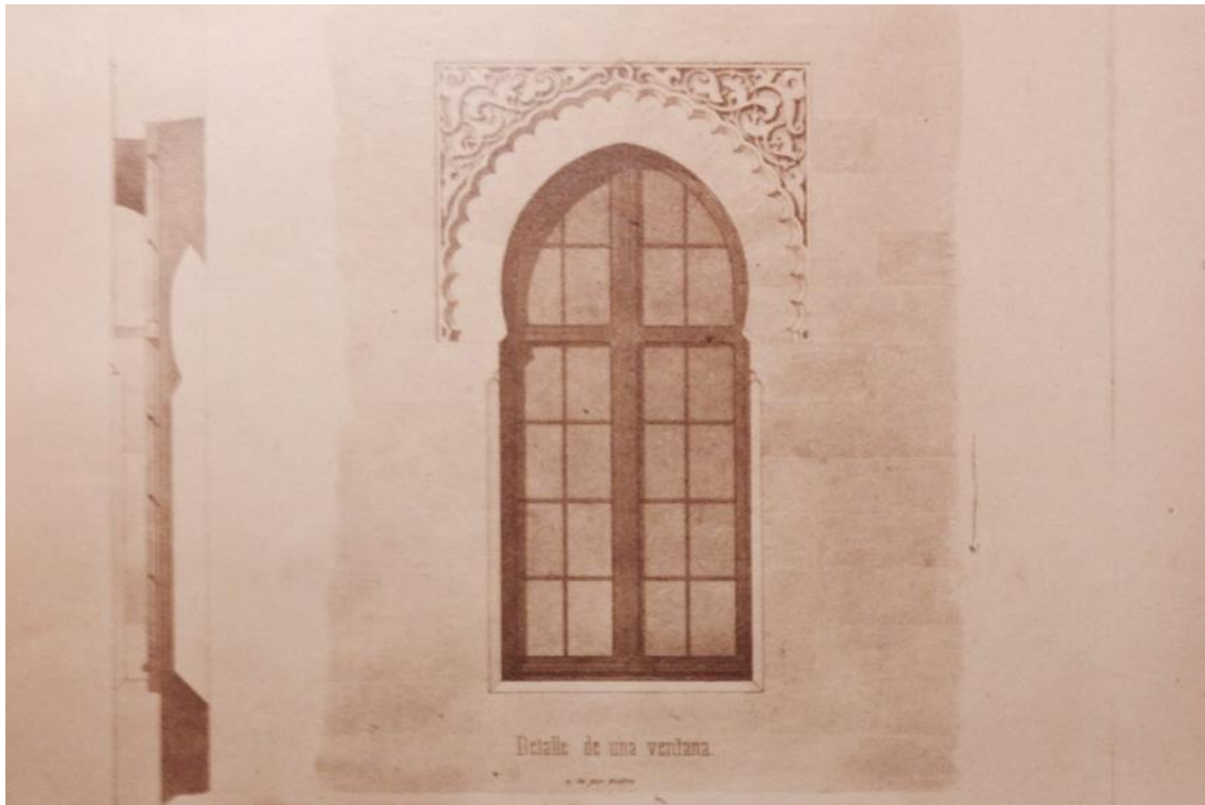
Fig. 45 Detalhe ornamentação janela de residência operária. Fonte: Xifré; Lauth, 1863
