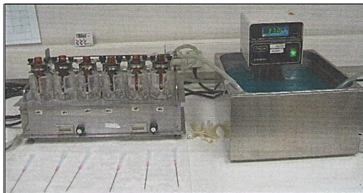
Figura 3.11. Equipo de muestreo manual de células de Franz
