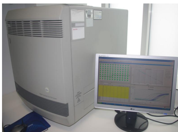
Figura 15: Los instrumentos que componen la plataforma 7900HT Fast Real-Time PCR.
