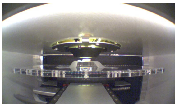
Figura 3.6. Fotografía del interior del equipo de \mu -XRF M4 Tornado TM (Bruker), destacando las dimensiones de la platina móvil donde se introducen las muestras para su análisis.
