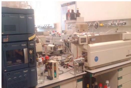
**Figura 12.** Sistema HPLC-MS/MS de los Servicios Científico-técnicos de la Universidad de Barcelona (Fotografía: Laia Gállego).
