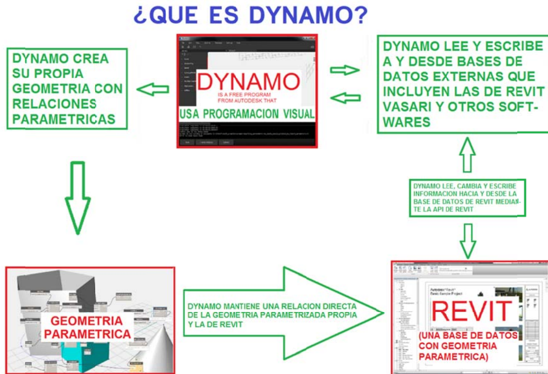
Figura 5.02. Dynamo lenguaje de programación visual VPL de código abierto, diseñado originariamente para Revit y Vasari, que utiliza un entorno visual gráfico, para la creación y edición de algoritmos paramétricos. Relaciones e interacciones entre los softwares Dynamo y Revit, en la definición geométrica de formas. Fuente: < http://simplydynamo.blogspot.com.es/2014/05/what-is-dynamo.html > Marcello Sgambelluri. 4 Traducción: Autor. Ver enlace < http://therevitcomplex.blogspot.com.es/ >. Acceso en 13 dic. 2016.
