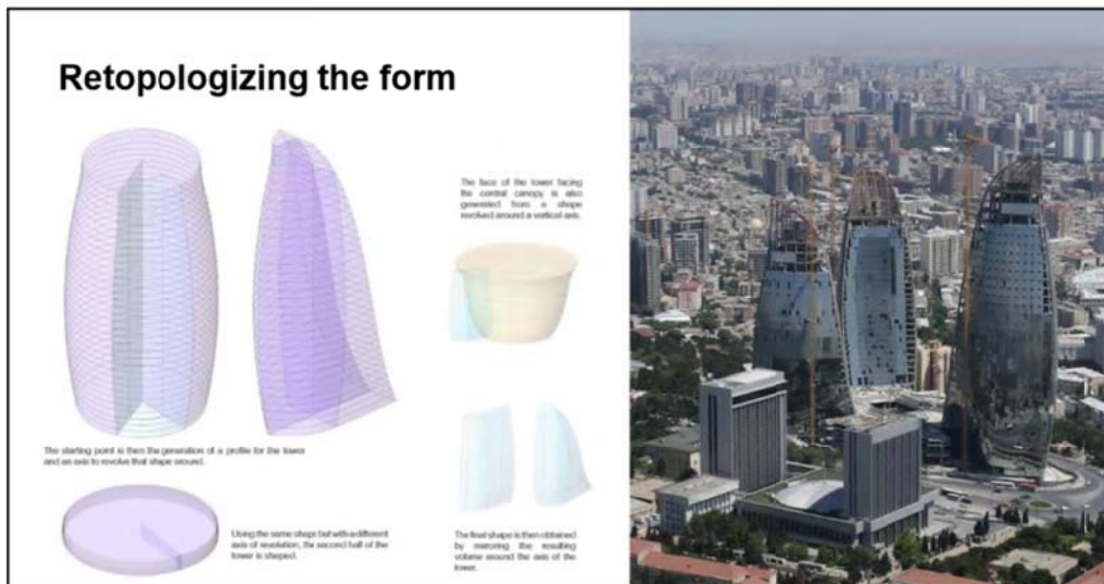
Figura 1.6. Estudios posteriores de control de formas, simulaciones y precálculos para la optimización y toma de decisiones en las diferentes fases de diseño de las Flame Towers en Baku (Azerbaiyan). Fuente: Autodesk University 2011. AB4700: You Want to Model a What? Converting Real Projects into Parametric Relationships. William Lopez Campo y Zach Kron.
