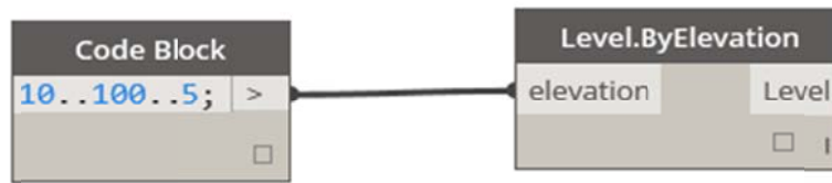
Figura 5.38. Detalle de la composición de los nodos necesarios y conectores en la programación visual dentro del entorno de trabajo de Dynamo, para la terminación del script de creación de niveles dentro del entorno de trabajo de Revit. Elaboración propia con software VPL.
