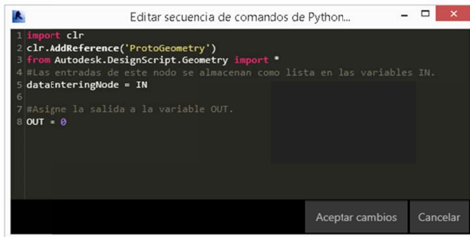
Figura 5.99. Ventana abierta del nodo “Python Script” que da paso a la incorporación de líneas de código de programación textual en lenguaje Python dentro de Dynamo. Elaboración propia con software VPL.
