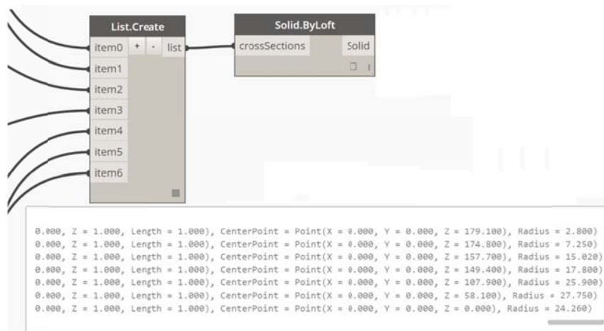
Figura 5.49. Detalle del listado de datos generado por el nodo “List.Create”. Previamente en ese mismo nodo se han introducido 7 items (uno por cada círculo generado desde el 0 al 6) haciendo clic sobre el signo (+), que aparece en su parte superior, estando conectados a los puertos de salida de cada círculo creado anteriormente. Elaboración propia con software VPL.
