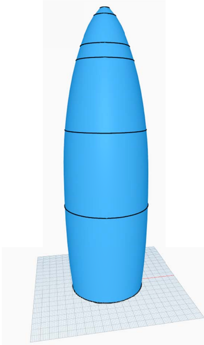
Figura 5.51. Detalle de la visualización del sólido creado en el entorno de trabajo de Dynamo, al ejecutar el script de su programación visual. Pueden verse los siete círculos, que han servido como referencia para el paso del sólido generado. Elaboración propia con software VPL.
