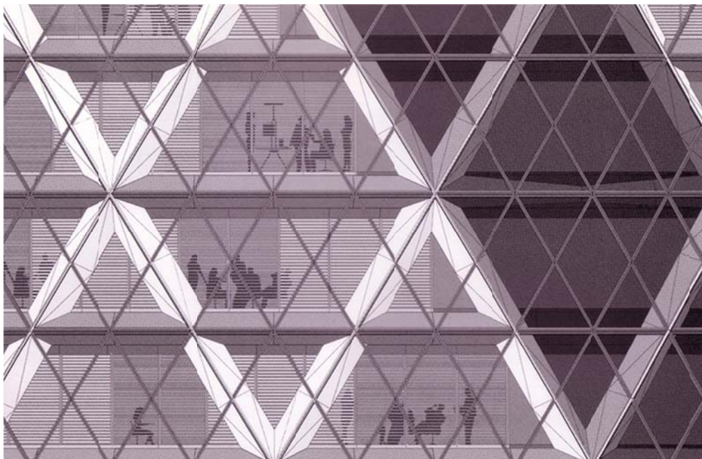
Figura 6.67. Detalle de la creación del perfil del borde de losa que será ejecutado en chapa de aluminio en los encuentros de las cabezas de forjado con el cerramiento de paneles acristalados de muro cortina de fachada. Fuente: © Norman Foster.
