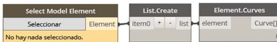
Figura 6.105. Nodos del editor gráfico de algoritmos para importar la curva spline del software de modelado y visualizarla. El primer nodo aparece en color naranja porque es necesario presionar la etiqueta Seleccionar para marcar luego los elementos a importar (curva spline). Elaboración propia con software VPL.
