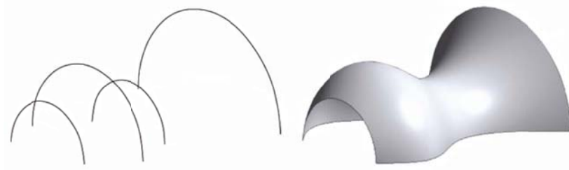
Figura 4.44. A la derecha Grado de definición 1 superficie de masa original después de su creación. A la izquierda pueden verse las primitivas o líneas básicas que guarda la superficie conformada y que son origen de su generación, se guardan dentro de la masa. Fuente: Autodesk University 2012, AB3555 “Beyond Massing: Conceptual Design Tools in Autodesk Revit Architecture”. David Fano.
