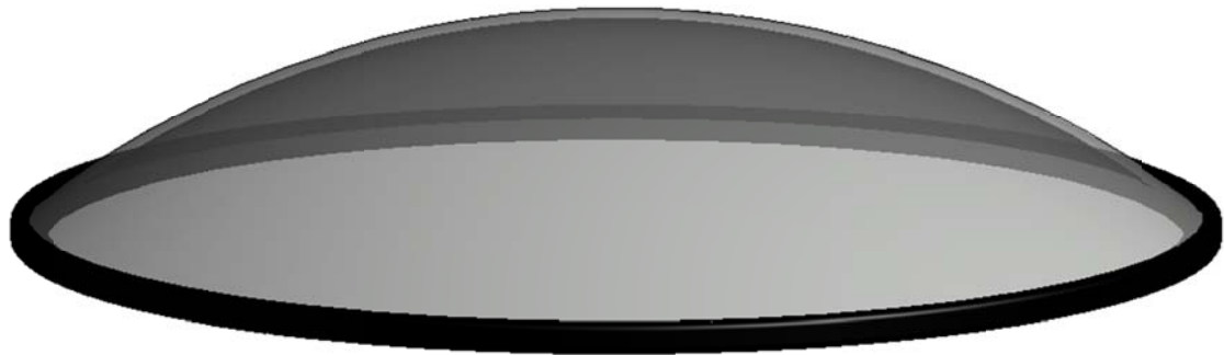
Figura 6.72. Vista de conjunto del detalle terminado de la cubrición acristalada del óculo de la cúpula. Elaboración propia con software BIM.
