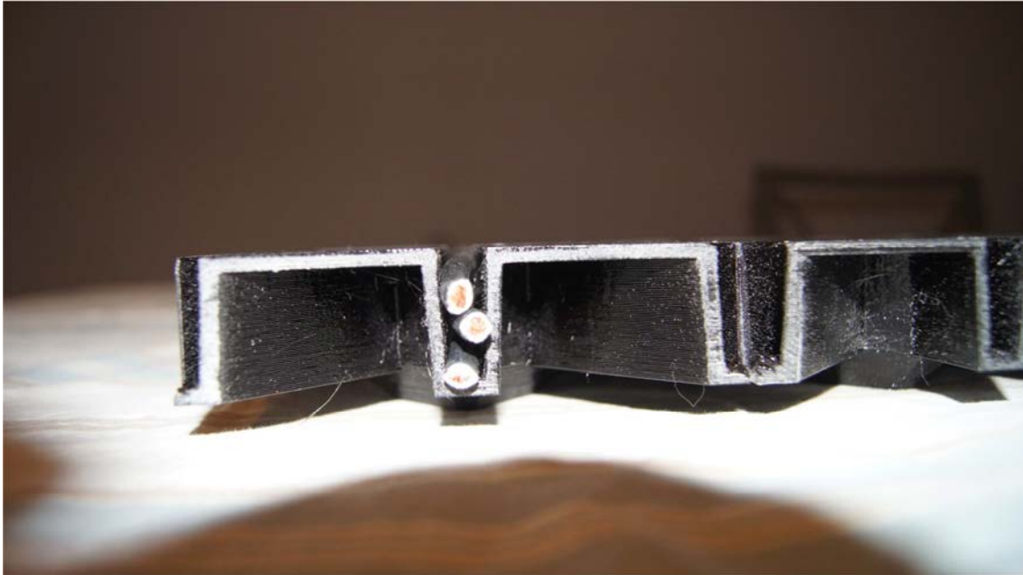
Fig. 65. Vista lateral de de la col·locació d'un traçat de 3 conductors de Ø6mm sobreposats sobre el prototip
