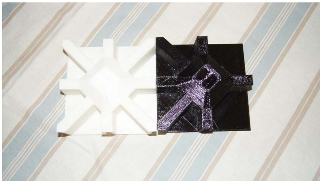
Fig. 58. Vista inferior dels prototips d'un mòdul comú (blanc) i un mòdul específic (negre)
