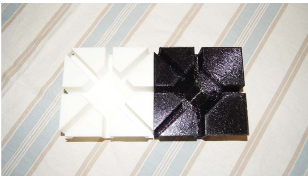
Fig. 57. Vista superior dels prototips d'un mòdul comú (blanc) i un mòdul específic (negre)
