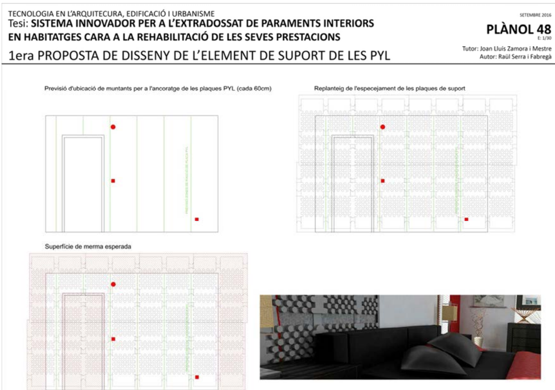
Plànol 48. Replanteig de l'especejament i merma esperada sobre parament tipus del disseny 1
