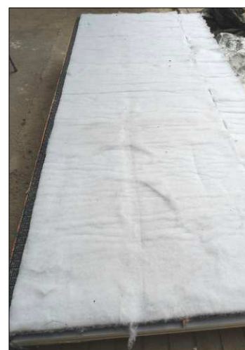
Imágenes 32 a 36 Compuesto multicapa y su adhesión a las PYL
