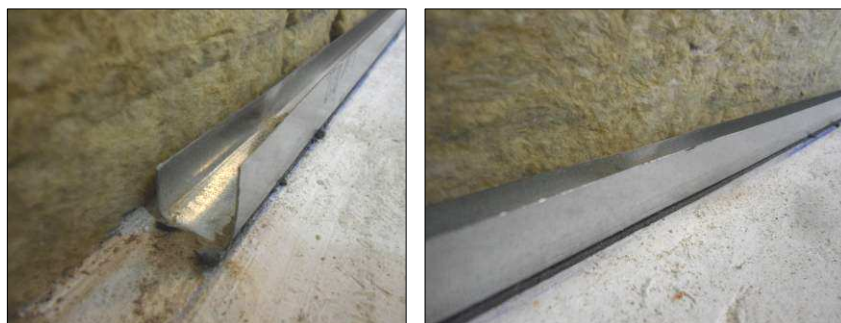
Imágenes 18 y 19 Instalación el perfil en U en marco portamuestras, delante la lana
