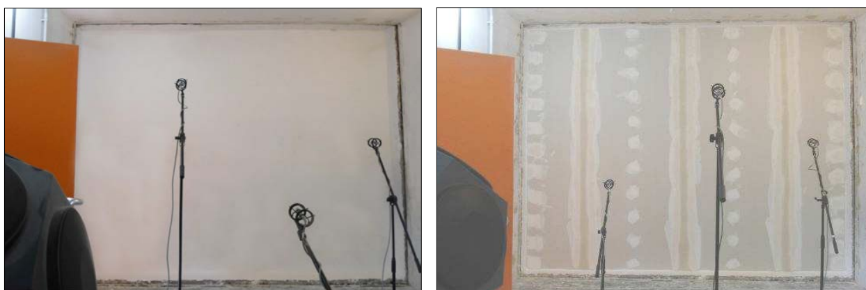
Imágenes 43 y 44 Pared de base sin y con el trasdosado, respectivamente, lista para ensayo
