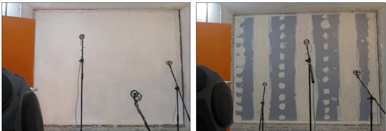
Imágenes 55 y 56 Pared de base sin y con el trasdosado, respectivamente, lista para ensayo
