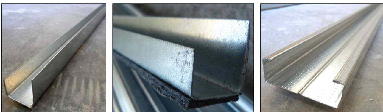
Imágenes 6 a 8 Perfil en U utilizado y con la banda elástica adherida, y perfil en C empleado como montante
