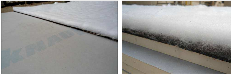
Imágenes 37 y 38 Compuesto multicapa adherido a la PYL
