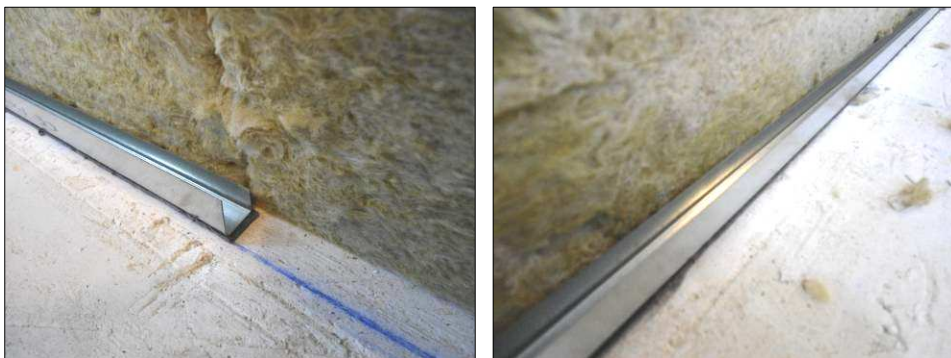
Imágenes 19 y 20 Instalación el perfil en U en marco portamuestras, delante la lana
