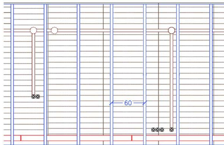
4 REPLANTEIG I COL-LOCACIÓ DE SUBESTRUCTURA TRASDOSSAT COL-LOCADOR PLACA PLA +40
