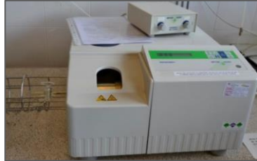
Figura 2.7. Termobalanza utilizada para la evaluación de la estabilidad térmica
