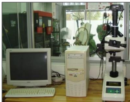
Figura 2.9. Medidor de microdureza utilizado para la determinación de la dureza Vickers de los termoestables preparados
