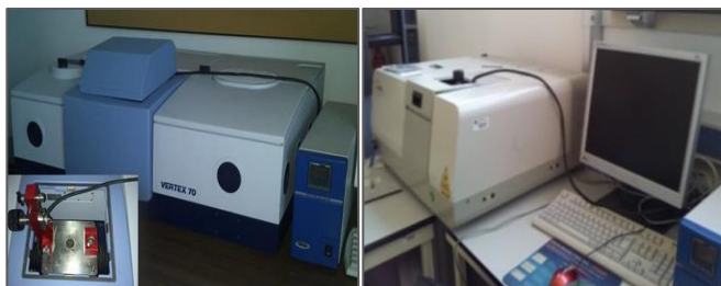
Figura 2.2. Equipos de FT-IR empleados en el seguimiento de las reacciones fotoquímicas (izquierda) y térmicas (derecha)
