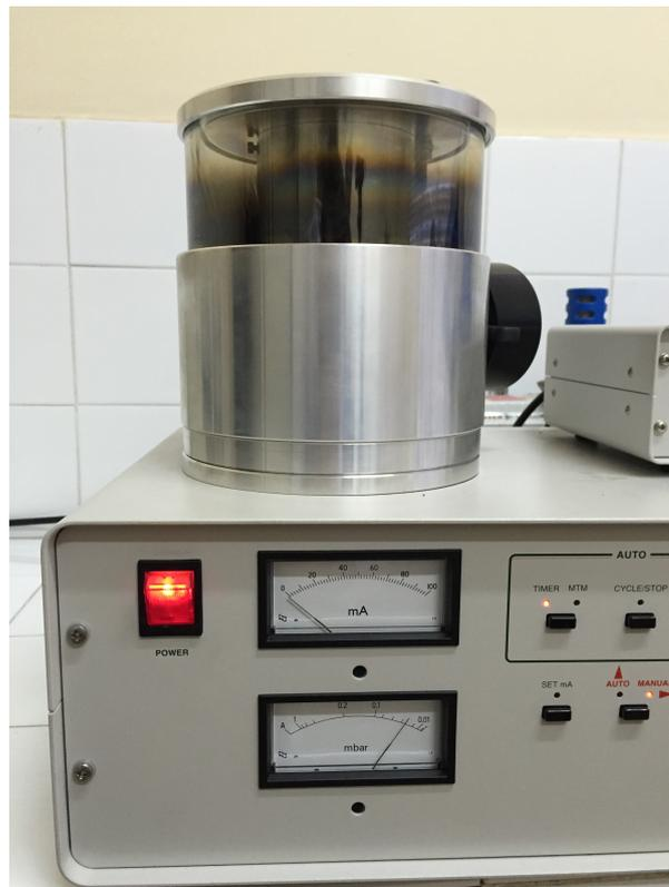
**Figura 5.** Arenado iónico de partículas de carbono (C) y platino (Pt) a 0,01mbar.
