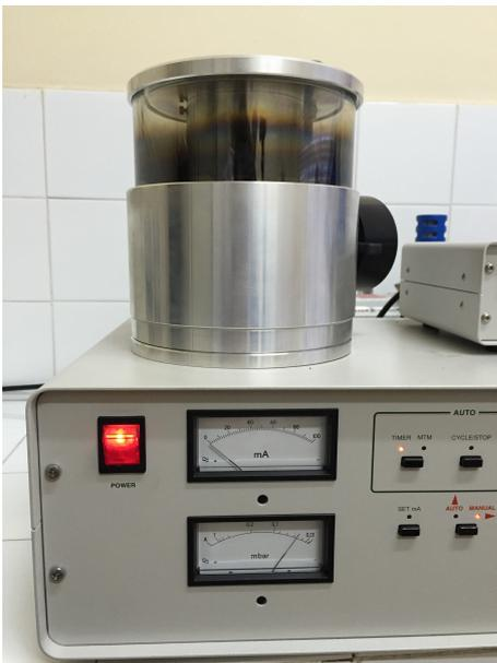
**Figura 15.** Arenado iónico de partículas de carbono (C) y platino (Pt) a 0,01mbar.
