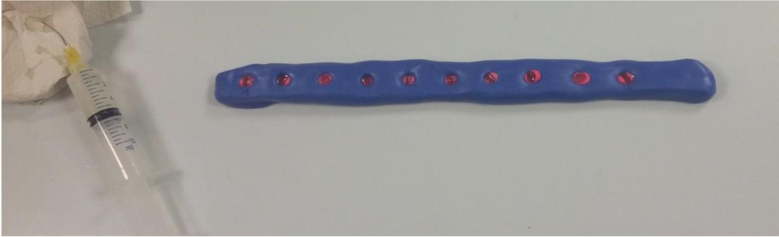
**Figura 14.** Confección de las réplicas. Vaciado mediante resina epoxi (EpoxiCure, Buehler, An ITW Company 41 Waukegan Road Lake Bluff, Illinois 60044 USA)
