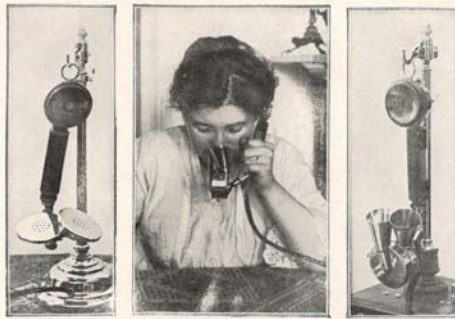
Le transmetteur téléphonique à deux microphones, un pour la bouche, un pour le nez.
