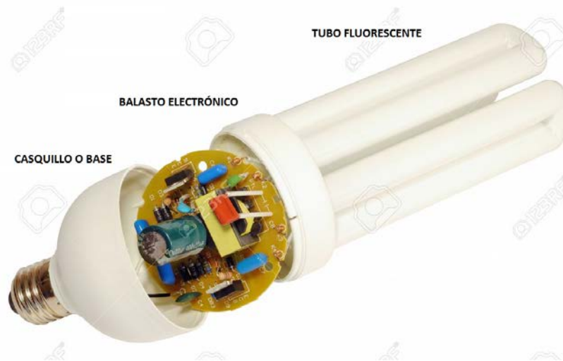
Figura 1.4. Vista de los componentes del balasto electrónico de una CFL. (Fuente: adaptado de es.123rf.com)
