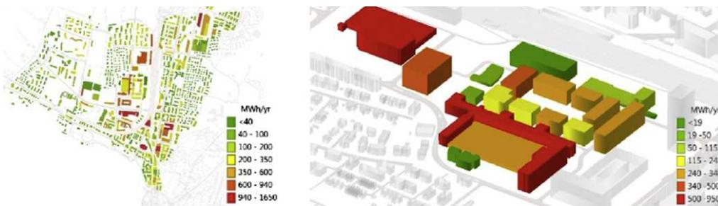
Figura 2.7. Potencial de reducción de energía mediante la mejora de los aparatos eléctricos en los edificios el área de estudio y en los edificios en la zona de interés(Fonseca y Schlueter. 2015) [4].
