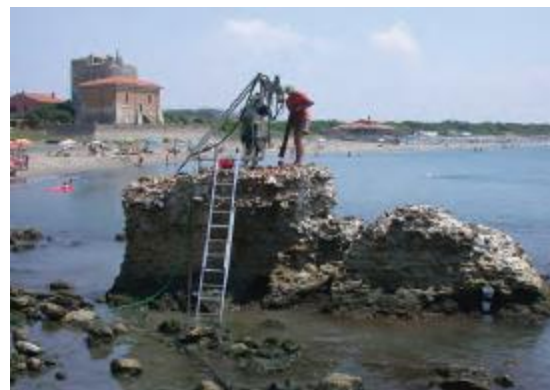
Fig. 115. Procedimiento de extracción del material de los pilares conservados en Cosa por parte del equipo de Romacons.
