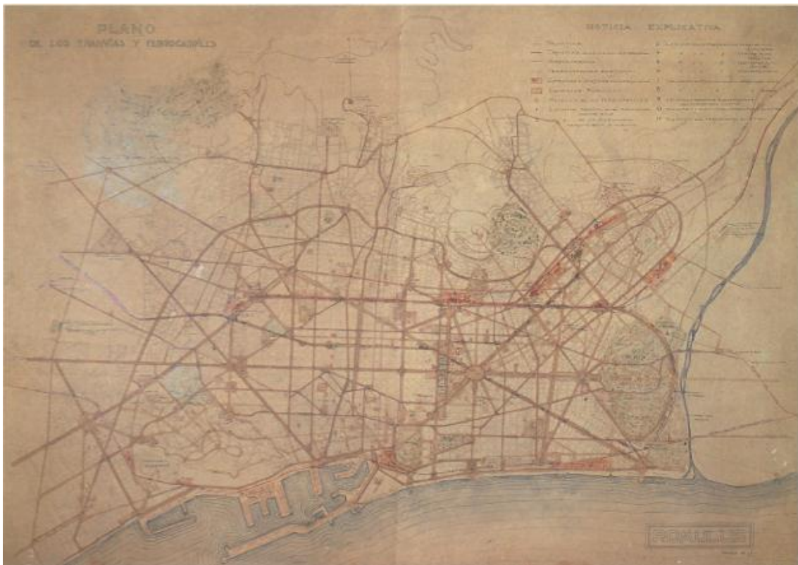
Figura 207: Esquema general de comunicación del Plan Jaussely. La circunvalación viaria y ferroviaria completa la radialidad de la ciudad tradicional. Fuente: IMHB. Proyete d'enllaços de Leon Jaussely, Plànol 9: plano de tranvías y ferrocarriles
