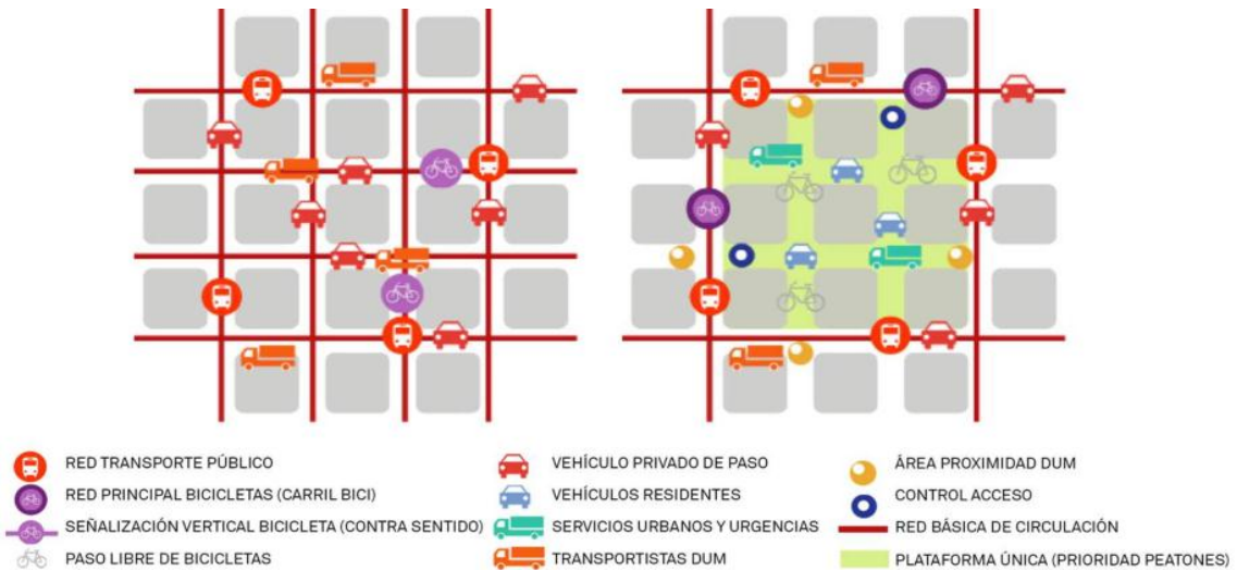
Figura 283: Modelo actual y modelo de supermanzana. Fuente: Ajuntament de Barcelona 2015: 305.
