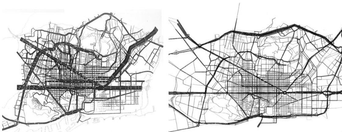
Figura 259: Diagrama de las rondas antes y después de las rondas de circunvalación. El tráfico se canalizaba por los ejes principales atravesando el centro del Eixample, la disminución del tráfico de paso con su distribución en las rondas permitió la reconversión de estos ejes en calles urbanas. Fuente: Busquets, J. 2004: 94
