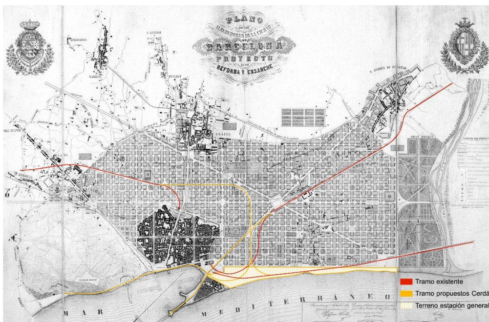
Figura 183: Esquema ferroviario del proyecto de Ensanche de 1859. Fuente: elaboración propia.
