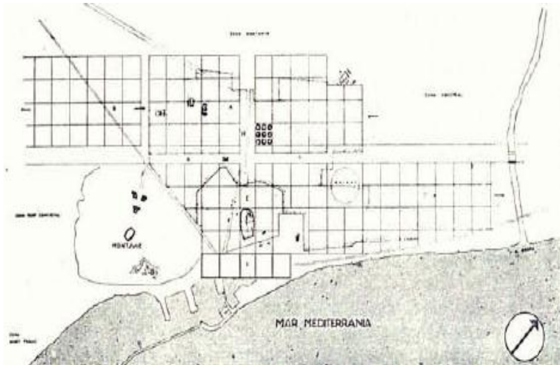
Figura 216: Esquema compositivo según el nuevo módulo de 400 x 400 metros. Fuente: Tarragó, S. 1962: 31
