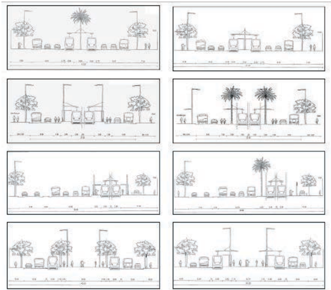
Figura 298: Secciones típicas de la red tranviaria. Fuente: Autoritat del Transport Metropolità.
