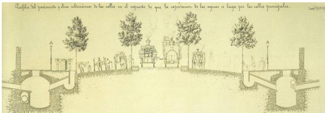
Figura 74: Principio de independencia de los medios de locomoción. Permite la circulación independiente de los tres grupos: transeúntes, cargados o no; coches y caballerías, cargadas o no; y una doble vía para el ferrocarril. De igual modo, denota la preocupación con las instalaciones (sanitarias, eléctricas, entre otras) y la utilización del subsuelo como soporte parte de la definición de la calle. Fuente: Cerdà, I. 1994: 206.
