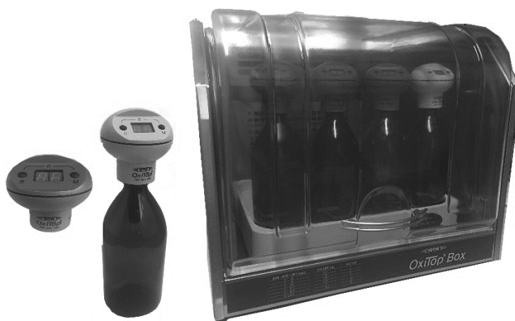
Figura 11. Equipo OxiTop® para la medición de la DBO. De izquierda a derecha, tapa medidora de presión, botella OxiTop® e incubadora llena de botellas OxiTop®.
