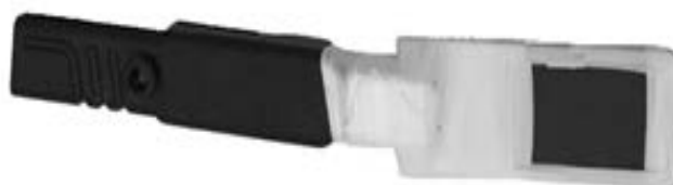
Figura 10. Ánodo de BDD utilizado en los ensayos.
