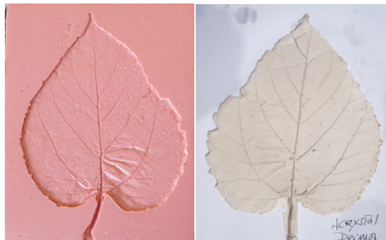
Figura 66. Molde en alginato Cavex 37 y positivo en resina de poliéster ecológica Acrystal primal.
