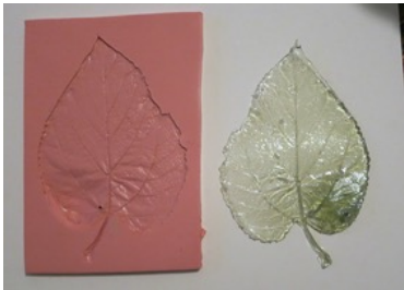
Figura 61. Molde en alginato Cavex 37 y positivo en resina de poliéster Resiglas.
