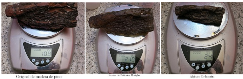
Figura 141. Original de madera pino de 108 g., resina de poliéster 210g., alginato Cavex 37 de 24g. de peso.
