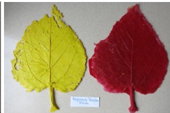
Figura 71. Piezas realizadas a partir del molde A en resina de poliéster teñida en rojo y amarillo.
