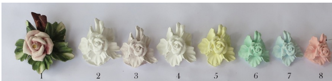
Figura 140. Detalle de las diferentes pérdidas de volumen según casa comercial.
