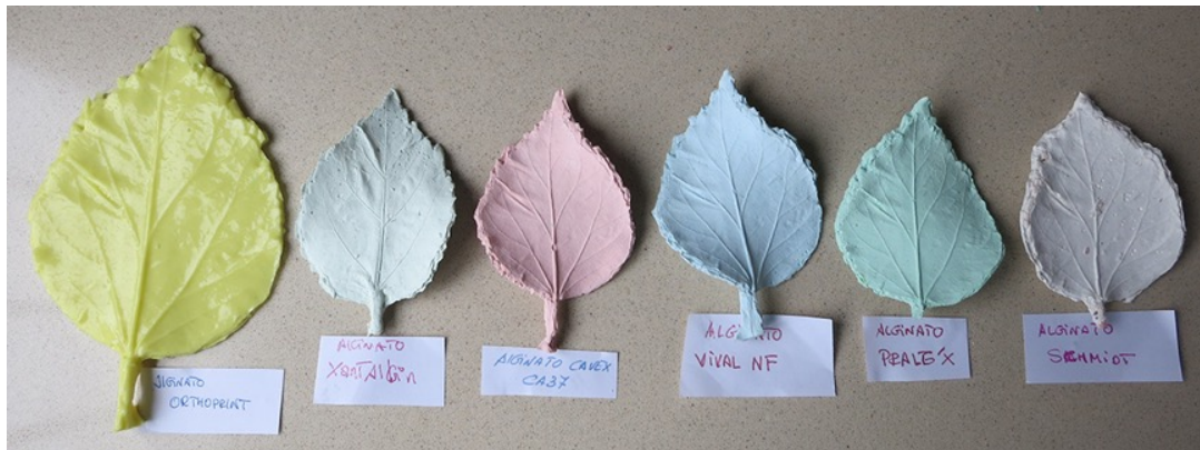
Figura 94. Colada fresca de figura Modelo B, realizada en Alginato Orthoprint y resto de coladas de distintas marcas comerciales deshidratadas de 7 días de evolución.
