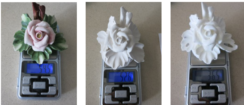
Figura 142. Original en porcelana. Positivo en yeso y positivo en resina Smooth-Cast .
