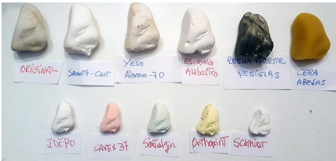
Figura 95. Comparativa entre alginatos y resto de materiales. Modelo C.
