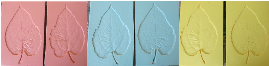
Figura 64. Moldes del modelo A (anverso y reverso) en Cavex 37 (rosa), Vival NF (azul) y Orthoprint (amarillo) realizados por el mismo procedimiento.
