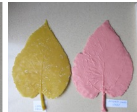
Figura 72. Piezas realizadas a partir del molde B en Cera virgen. Alginato Cavex 37.
