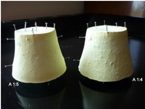
Ilustración 40. Modelo de pieza A con distintas proporciones de soluto y disolvente.
