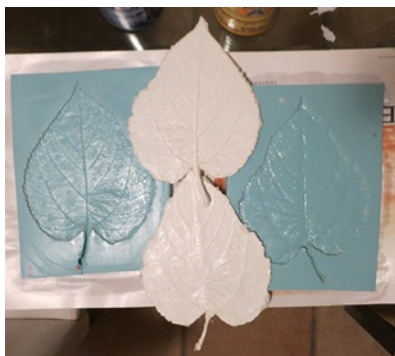
Figura 65. Molde en Alginato Vival NF y positivo en resina de poliuretano Smooth-Cast 300.
