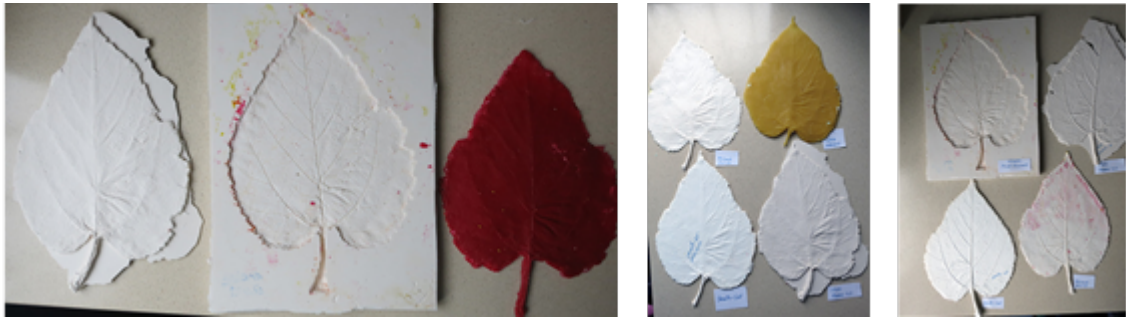
Figura 69. Molde en silicona RTV y positivos en escayola Ultracal, Álamo, Cera Virgen, Resina de poliéster, de Poliuretano y silicona Silastic.
