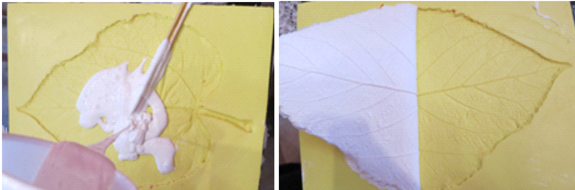
Figura 67. Molde en alginato Orthoprint y positivo en silicona RTV.
