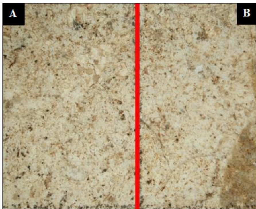
Figura 9.8. Imagen de microscopía estereoscópica (1 x) de la superficie de la pintura mural antes del tratamiento (A) y después del tratamiento con la muestra de hidroxiapatita HA1 (B).
