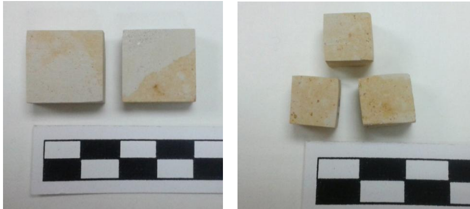
Figura 7.11. Probetas de soporte pétreo de dolomía utilizadas en la evaluación de los tratamientos de consolidación y protección con las tres muestras preparadas.
