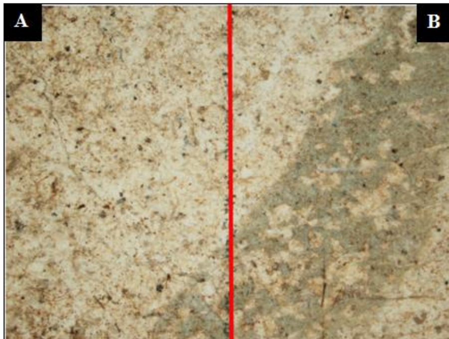
Figura 9.2. Imagen de microscopia estereoscópica (1 x) de la superficie de la pintura mural antes del tratamiento (A) y después del tratamiento con la muestra ACP (B).
