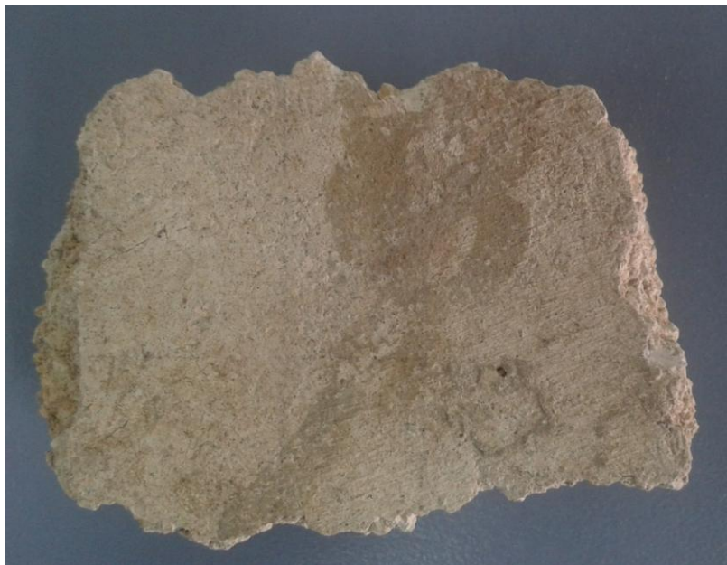
Figura 7.12. Fragmento de pintura mural del siglo I d.C. procedente de la Casa de Ariadna en Pompeya utilizado en la evaluación de la acción consolidante y protectora de las muestras con estequiometría de hidroxipatita.
