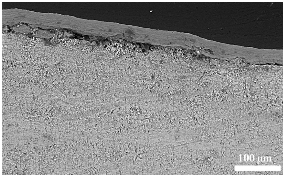
Figura 10.6. Imagen por SEM en modalidad electrones retrodispersados de un corte transversal del fragmento de marfil tratado con la muestra ACP. Se observa la formación de la capa superficial.
