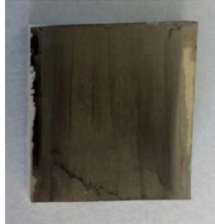
Figura 4. 8 Fotografía tras la deposición de la tinta basada en etanol sobre el sustrato cerámico CI y su posterior secado en placa calefactora.
