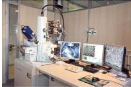
*Figura 3. 14 Equipo de microscopía electrónica de barrido utilizado.*
