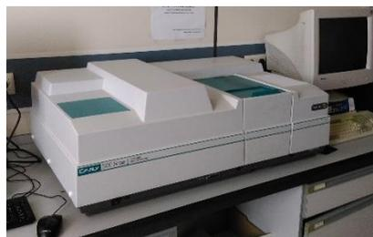
Figura 3. 18 Espectrofotómetro Cary 500 UV-VIS-NIR.
