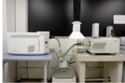
Figura 3. 17 Equipo simultáneo TGA/SDTA Mettler Toledo modelo TGA/SDTA851e/LF/1600.
