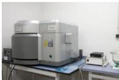
Figura 3. 16 Espectrómetro Raman dispersivo Jasco NRS-3100.
