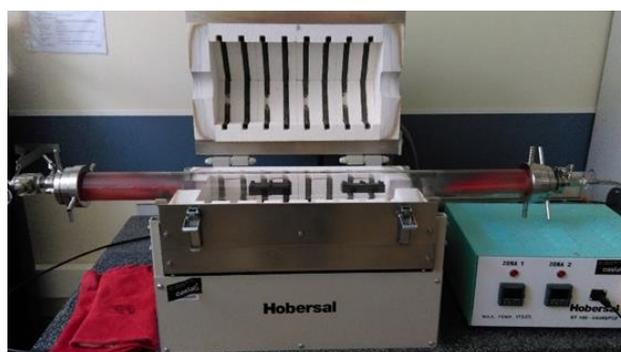
*Figura 3. 9 Horno tubular equipado para trabajar en vacío..*
