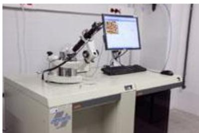
*Figura 3. 19 Microscopio de fuerza atómica (MFA) JEOL JSPM.*
