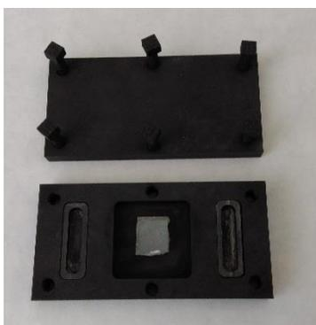
*Figura 3. 10* Caja de grafito usada en el trabajo.
