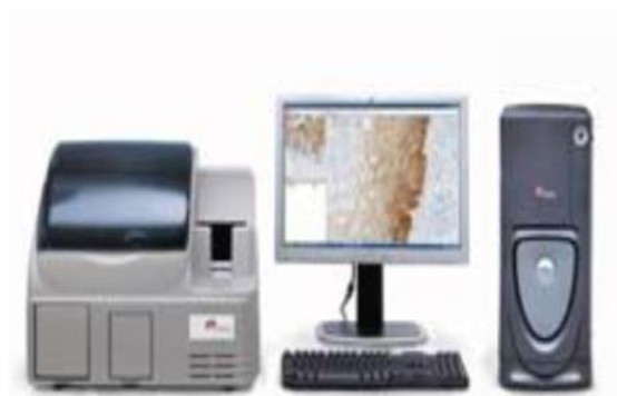
Figura 4: ACIS® III Instrument, conectado a un ordenador al que se envían los datos. El lector de las muestras se encuentra en la ranura de la izquierda del instrumento.
