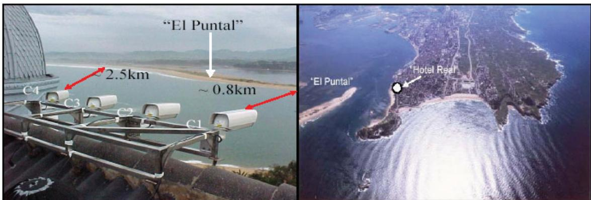
Figura 2.2. Localización de las cámaras en la ciudad de Santander. A la izquierda se muestra un detalle de la batería de cámaras utilizada para observar la playa del Puntal.
