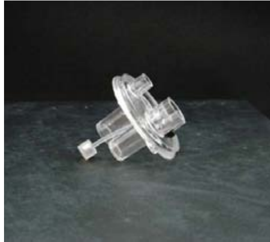
Figura 8.4.2. Esquerra: disseny del pèndol flexible amb una cavitat (a la part inferior) on posicionar i segellar un imant. Dreta: detall de la tapa d'un minibioreactor que incorpora encaixat a un forat situat al seu punt central un pèndol de silicona flexible amb un imant a la seva part inferior.
