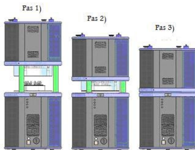
Figura 8.2.13. Esquema de l'operació de tancament del sistema.
