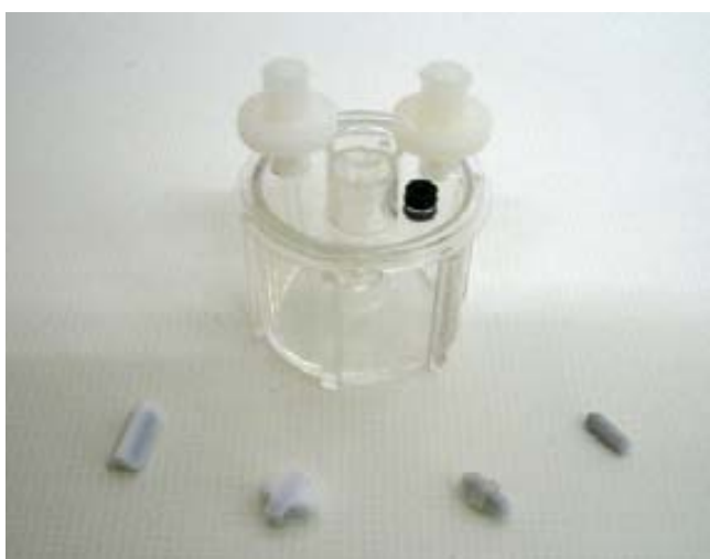
Figura 5.3.1. Detall de les configuracions de vareta imantada. D'esquerra a dreta: prisma triangular, creu, cilindre amb anella i cilindre
