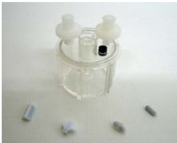
Figura 8.4.1. Detall de les varetes magnètiques emprades. D'esquerra a dreta: prisma triangular, creu, cilindre amb anella i cilindre
