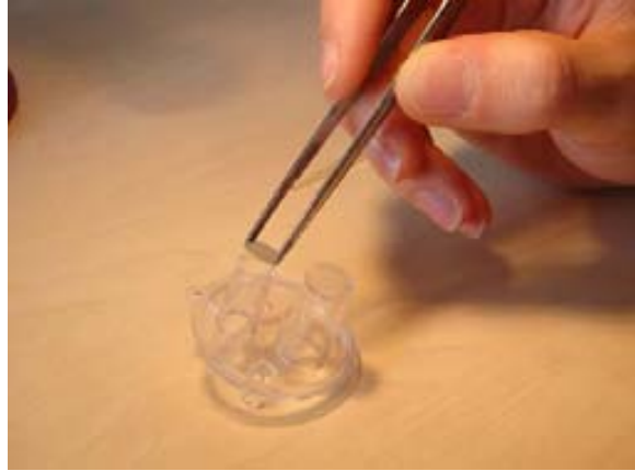
Pas 2. Posicionar la membrana sobre el port polarogràfic
