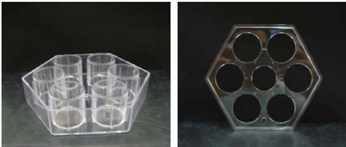
Figura 8.2.10. Fotografies de les peces comunes de la placa de sis minibioreactors (base i tapa intermèdia).
