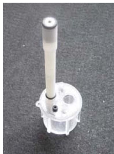
Figura 8.3.4. Prototip de sonda polarogràfica realitzat mitjançant tècniques de rapid prototyping.
