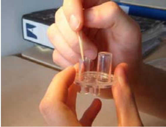
Pas 1. Escampar gota de solució de silicona amb l'ajut d'una punta de pipeta
