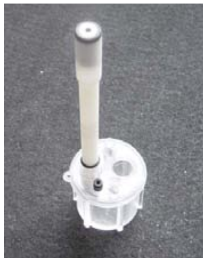
Figura 5.2.15. A) Esquema del minibioreactor, on la tapa té un port per a situar la sonda d'oxigen dissolt, que encaixa al port per mitjà de la seva conicitat (idèntica a la del port), així com per la presència d'una junta tòrica de fixació. La membrana de silicona en malla metàl·lica es troba adherida al port també mitjançant silicona, sense la presència de cap junta tòrica que la separi de la sonda. B) Fotografia d'un minibioreactor amb la sonda d'oxigen encaixada al port corresponent.
