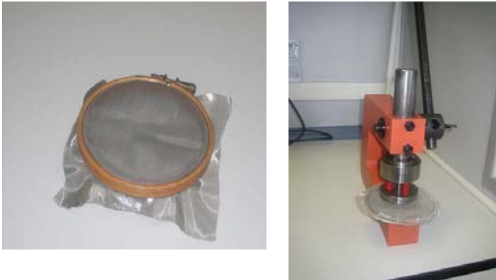
Figura 8.1.4. Esquerra, bastidor amb la membrana d'acer inoxidable. Dreta, premsa amb la matriu per a tallar cercles de 6,3 mm de diàmetre.
