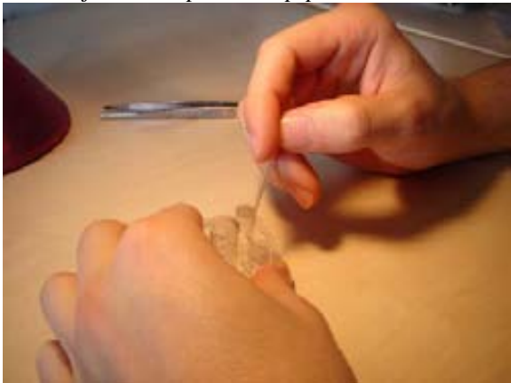
Pas 3. Escampar una gota de solució de silicona per a segellar la membrana des de l'exterior del port polarogràfic
