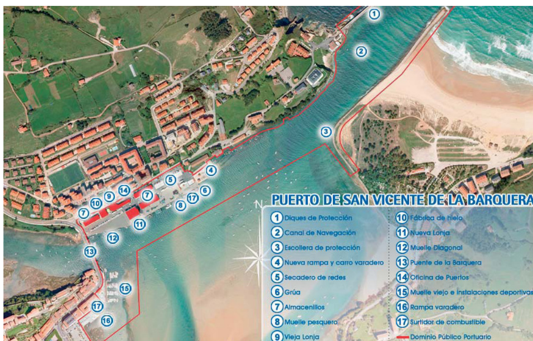
Fotografía 44: Distribución del puerto de San Vicente de la Barquera. Fuente: Puertos de Cantabria.
