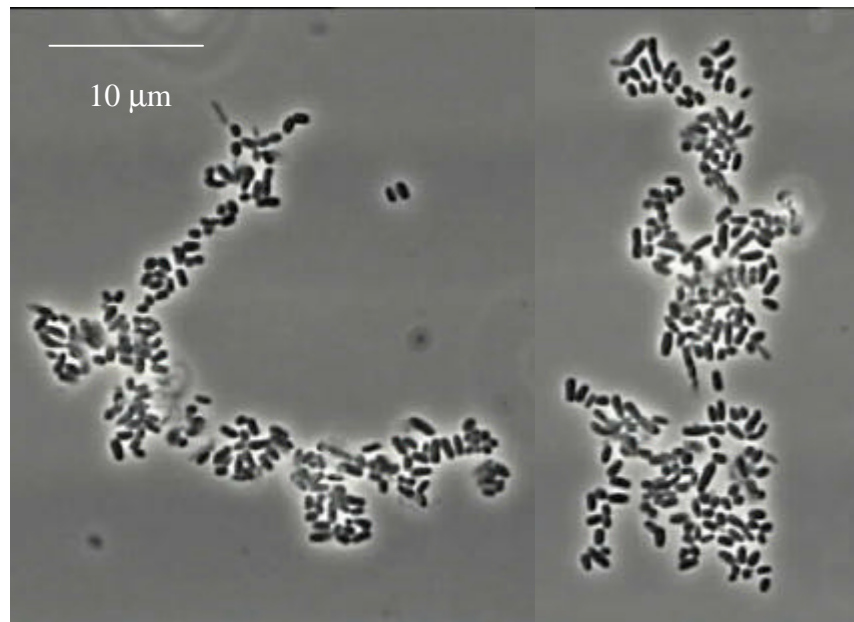
Figura 4.230.- Fotografías realizadas mediante microscopio óptico (1000 aumentos, contraste de fases) de fragmentos de biopelícula desprendidos en suspensión en el medio líquido del reactor.
