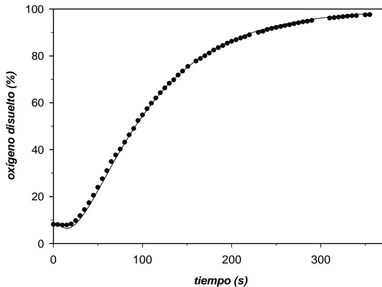
**Figura 4.308.- Representación gráfica de la evolución de la concentración de oxígeno disuelto durante uno de los experimentos de determinación del coeficiente de transferencia de materia de la fase gas a la líquida. La línea continua representa el ajuste numérico realizado (método de mínimos cuadrados no lineal).**
