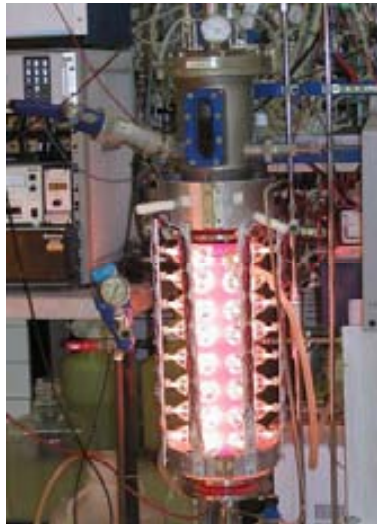
Figura 3.3: Fotobiorreactor Bioengineering, de 8 L de volumen útil.
