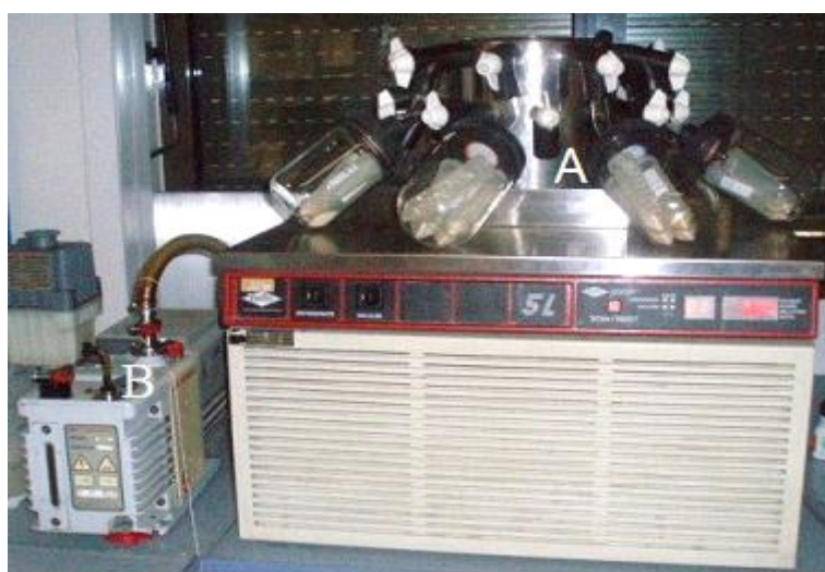
Fig. 4.14.- Liofilizador Virtis Sentry modelo Benchtop 5L (A) y una bomba de vacío Edwards modelo RV5 (B), equipos utilizados en el tratamiento de las muestras de rLip2.
