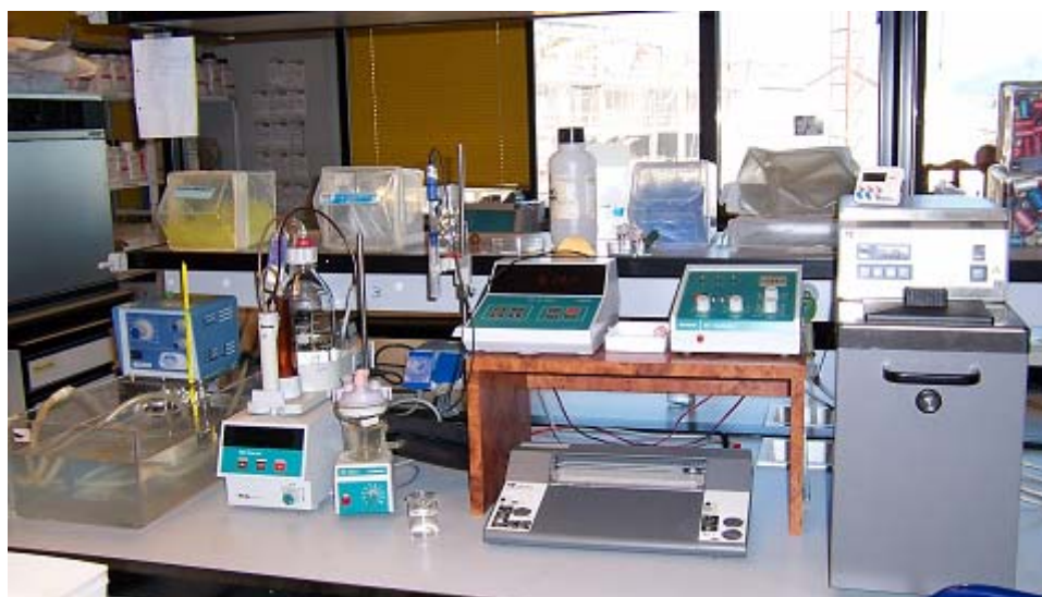
Fig. 4.15.- Fotografía del pH-Stato utilizado para el análisis de la degradación de triglicéridos y para los estudios de estabilidad (pH-Temperatura) de la enzima rLip2.
