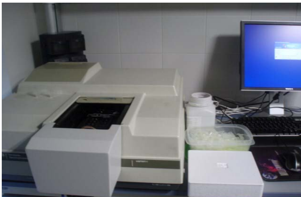
Fig. 4.12.- Espectrofotómetro UV-VIS Varian Cary3, instrumento utilizado para el análisis de actividad lipásica y degradación de para-nitrofenoles.
