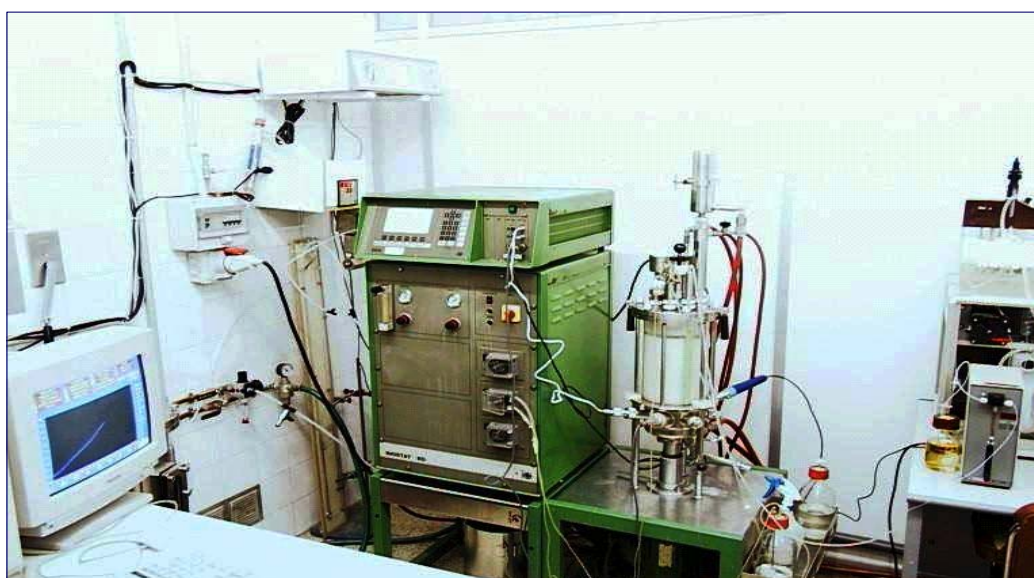
Fig. 4.9. Reactor discontinuo en cultivo de P. pastoris . Se aprecia en la figura las microburetas de alimentación y la unidad de control de parámetros DCU, además del ordenador de control de fermentación.
