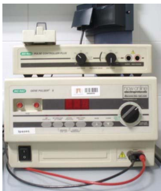
Fig. 4.7.- Electroporador, equipo utilizado para la integración de material genético tanto para E. coli como para P. pastoris .
