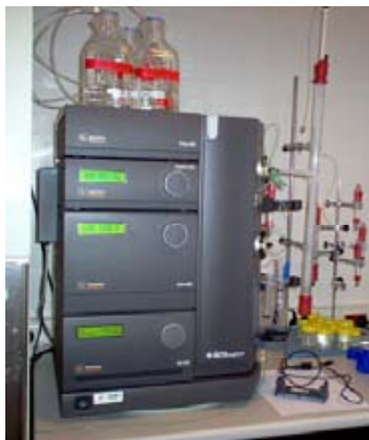
Figura 9.16. Sistema de cromatografia líquida FPLC, ÄKTAexplorer 100. De baix a dalt es mostren els mòduls P-900, UV-900, pH/C-900 i BOX-900.
