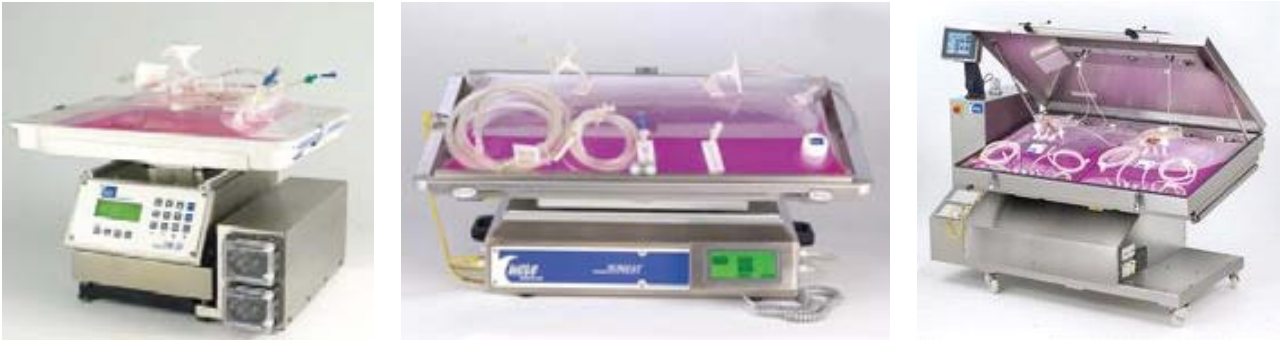
Figura 2.20. Tipus de bioreactors d'un sol ús ( Wave Bioreactor ) amb diferents volums operacionals.
