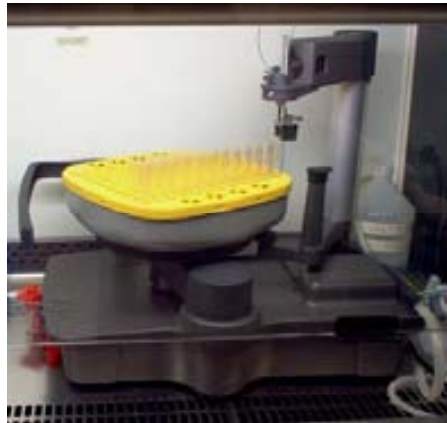
Figura 9.17. Col·lector de fraccions Frac-950 amb el rack A (base de color groc).
