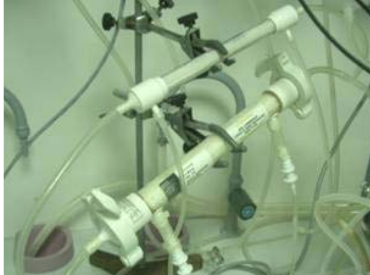
Figura 5.17. Detall del muntatge experimental operant en continu amb perfusió: conjunt de filtres de fibres buides doblat.
