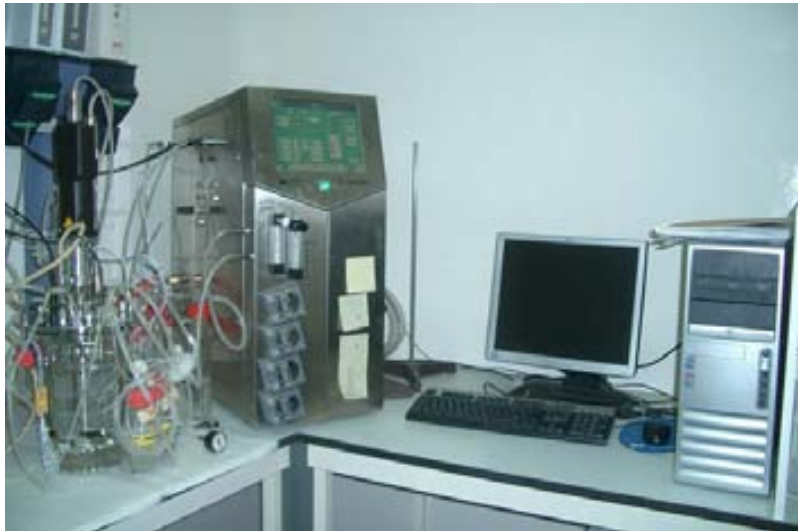
Figura 5.5. Bioreactor de tanc agitat Biostat Bplus (cuba de 2 L i DCU) i ordinador de gestió.
