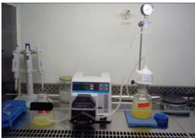
Figura 6.8. a) Muntatge experimental utilitzat en la microfiltració; b) Esquema del muntatge.
