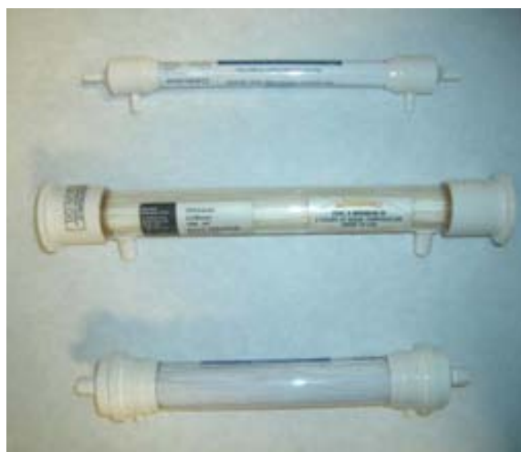
Figura 9.4. Mòduls de microfiltració emprats en el treball. De dalt a baix es mostren els models Cellflo (C22M-011-01N), HFC (CFP-2-E-5A) i Cellflo (C22M-021-01N).
