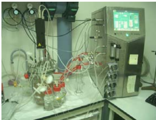
Figura 9.1. Bioreactor Biostat Bplus: a l'esquerra, cuba de fermentació amb el motor d'agitació situat a sobre; a la dreta, DCU.
