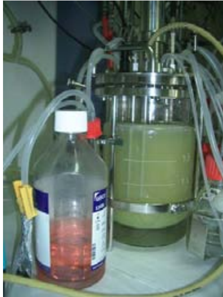
Figura 5.23. Detall de la producció en continu amb perfusió: cultiu al final de la fase d'infecció, destaca el color verdós característic de l'elevat nivell d'expressió de la proteïna GFP, respecte la coloració original del medi de cultiu.
