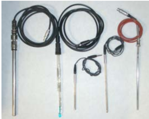
Figura 9.2. Sondes bàsiques associades al bioreactor de tanc agitat, d'esquerra a dreta: sonda d'oxigen dissolt, sonda de pH, sonda de detecció d'escumes, sonda de nivell i sonda de temperatura.
