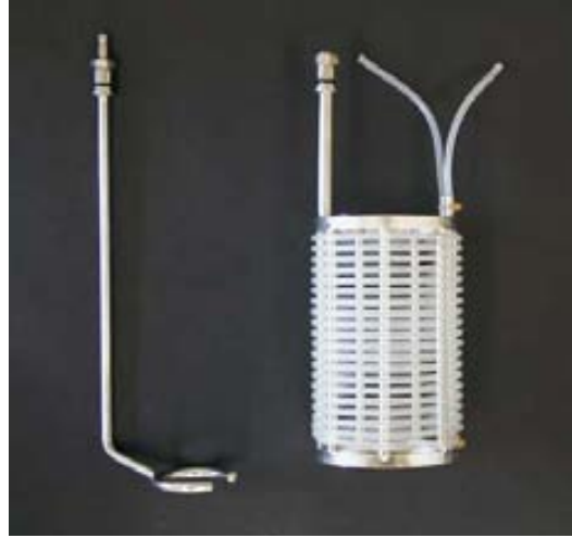
Figura 9.3. Sistemes d'aeració en el bioreactor de tanc agitat emprats en el treball. D'esquerra a dreta es mostren el difusor d'anell perforat i la membrana tubular de silicona.
