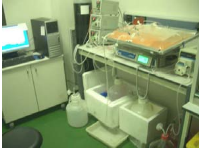
Figura 5.41. Sistema no convencional ( Wave Bioreactor ): muntatge experimental operant en continu amb perfusió.
