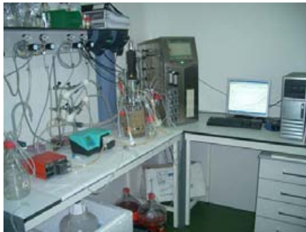
Figura 5.15. Sistema convencional (bioreactor Biostat Bplus): muntatge experimental operant en continu amb perfusió.
