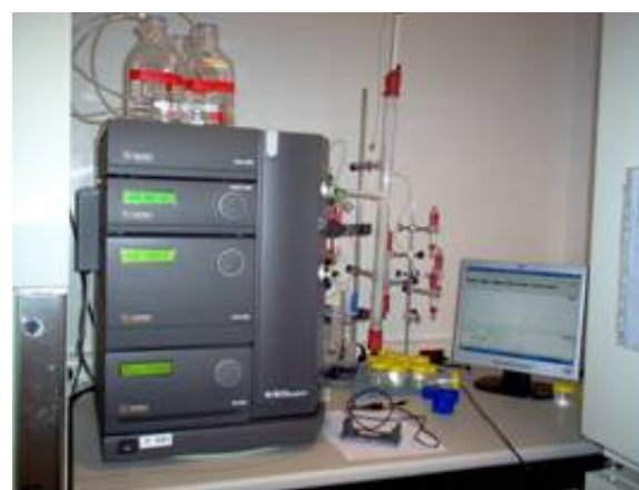
Figura 6.19. Esquema dels elements que integren el sistema de cromatografia líquida de baixa pressió (FPLC) ÄKTAexplorer [44].
