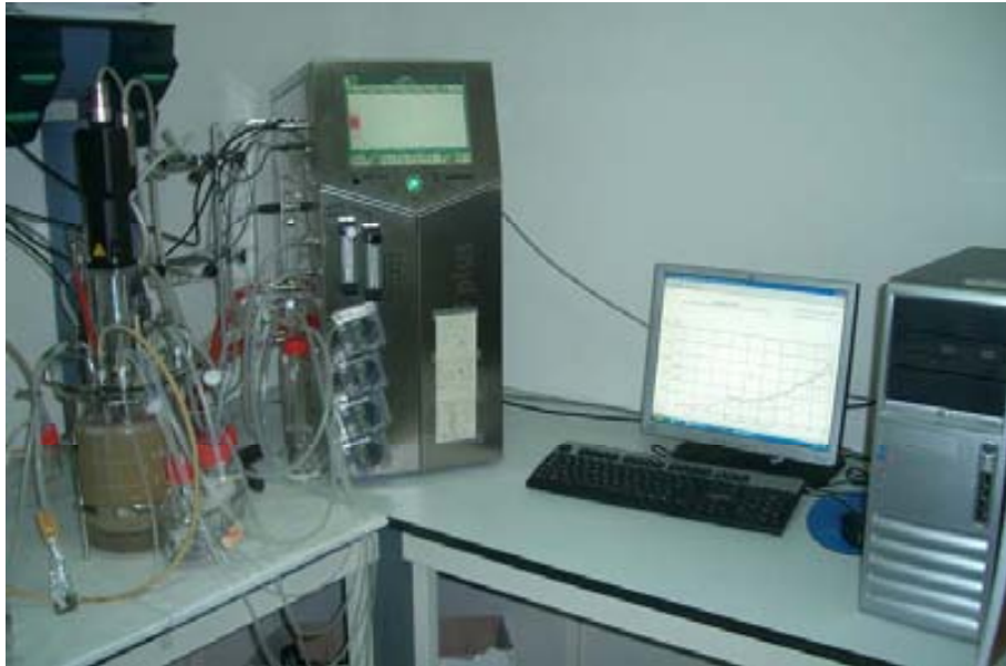
Figura 5.8. Sistema convencional (bioreactor Biostat Bplus): muntatge experimental operant en discontinu.
