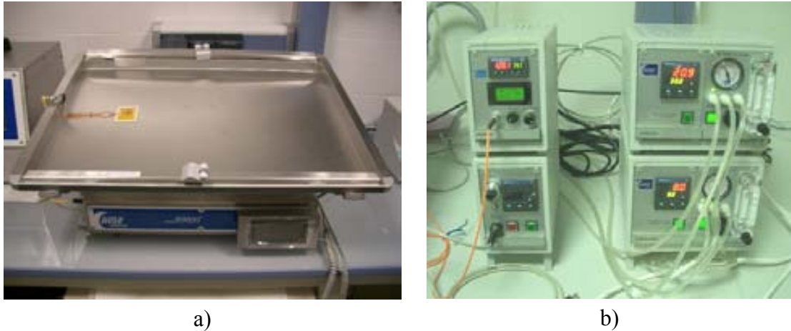
Figura 9.7. Components del Wave Bioreactor System20/50EHT : a) Base i plataforma de cultiu amb la sonda de temperatura incorporada; b) Mòduls de mesura (esquerra) i estacions de mescla de gasos (dreta).
