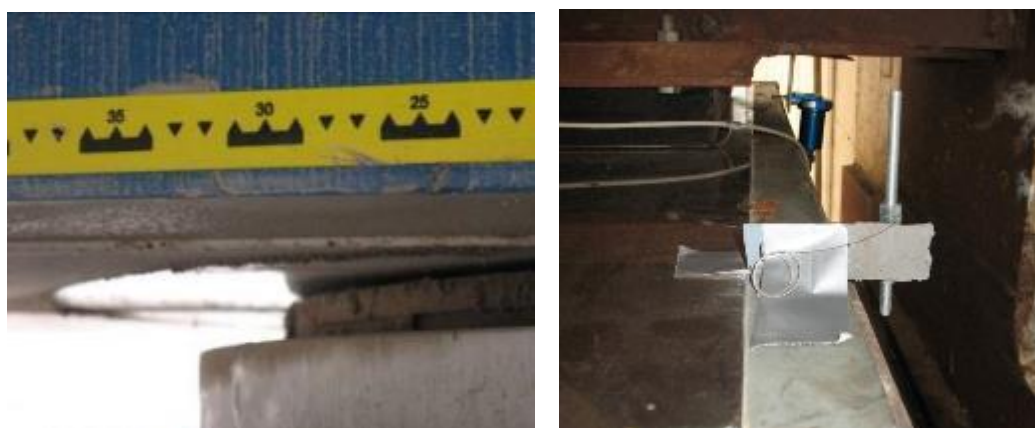
Figura 7. Medida del movimiento relativo tablero-pila. (APIA XXI, S.A.)
