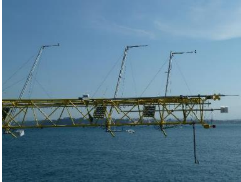
Figura 158. Boya III. Boya en posición abatida en dique. Anemómetros en distintas secciones. APIA XXI, S.A.
