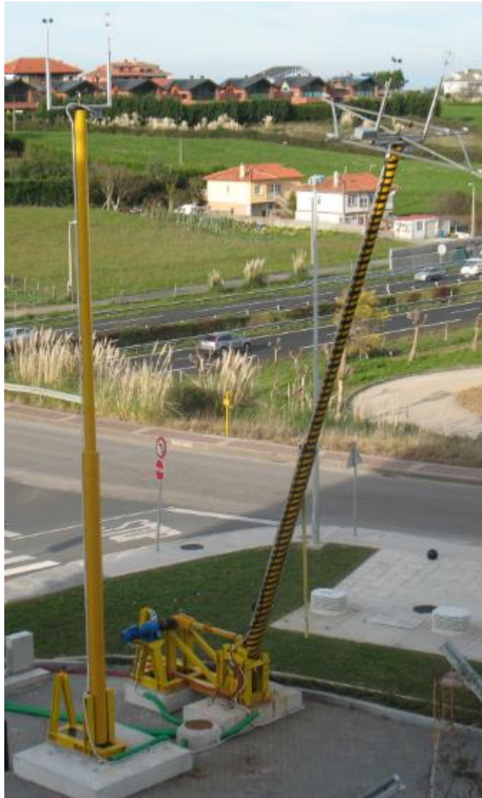
Figura 159. Mástiles de experimentación para el estudio de la influencia del movimiento en las lecturas de los anemómetros de cazoletas y ultrasónicos. APJA XXI, S.A.
