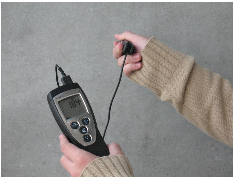
Figura 34. Medida de la temperatura en alma de sección cajón del Viaducto río Huerva (LAV Madrid-Zaragoza).
