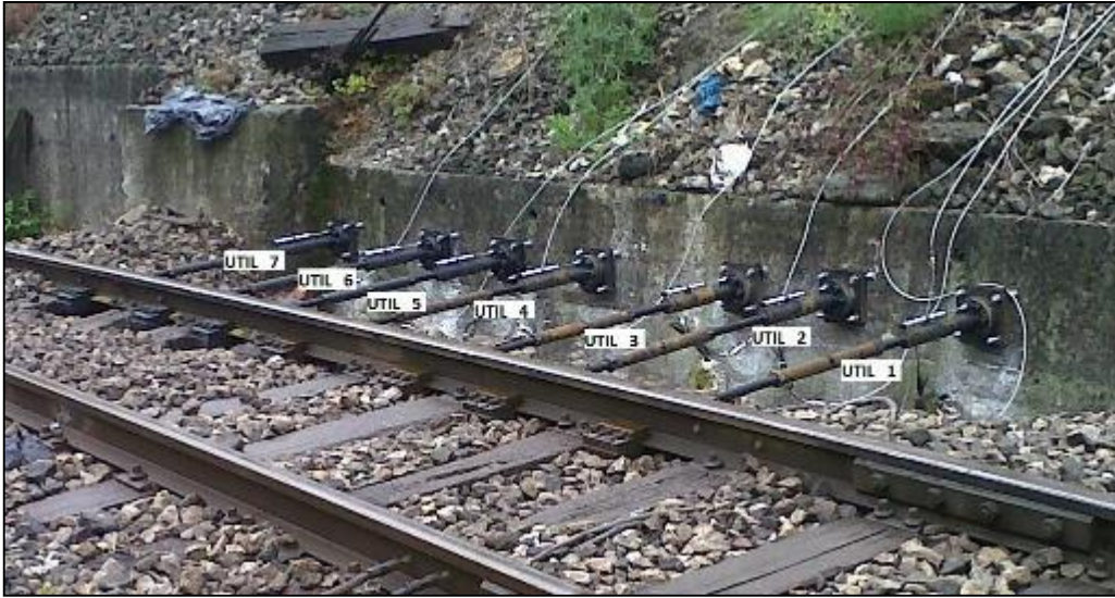
Figura 156. Instrumentos de medición de desplazamientos colocados en vía de estrecho métrico en La Cavada (Cantabria).
