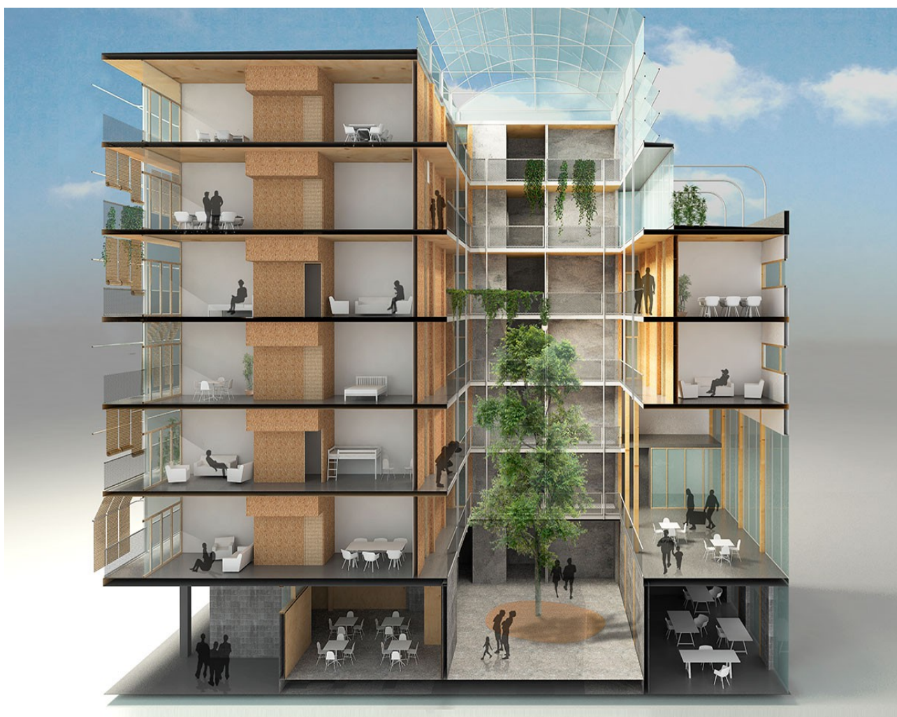
Fig. 6.24: Sección transversal del edificio. Fuente: La Col
